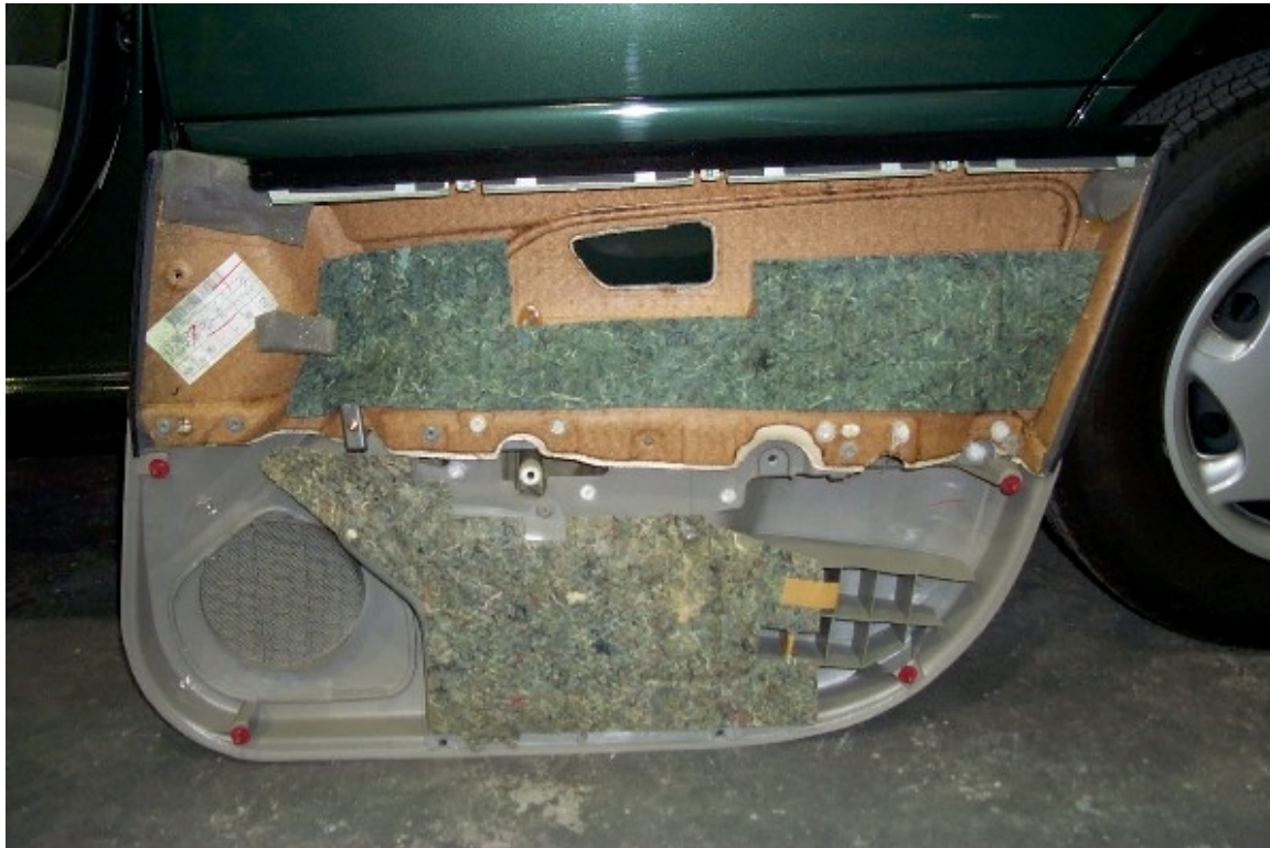
31. Mousse de protection située dans la garniture de la porte avant gauche. Protective foam located in left front door trim.
