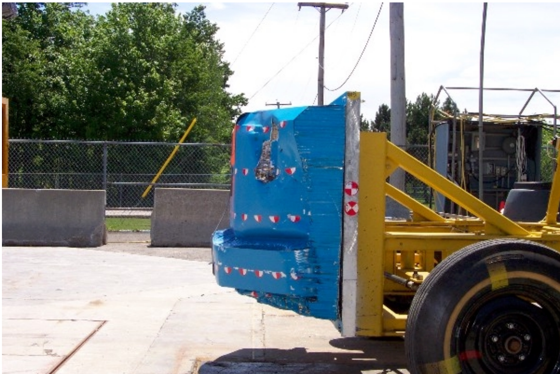
20. Vue du côté gauche de la face déformable, après essai. Left side view of the deformable face, post-test.
