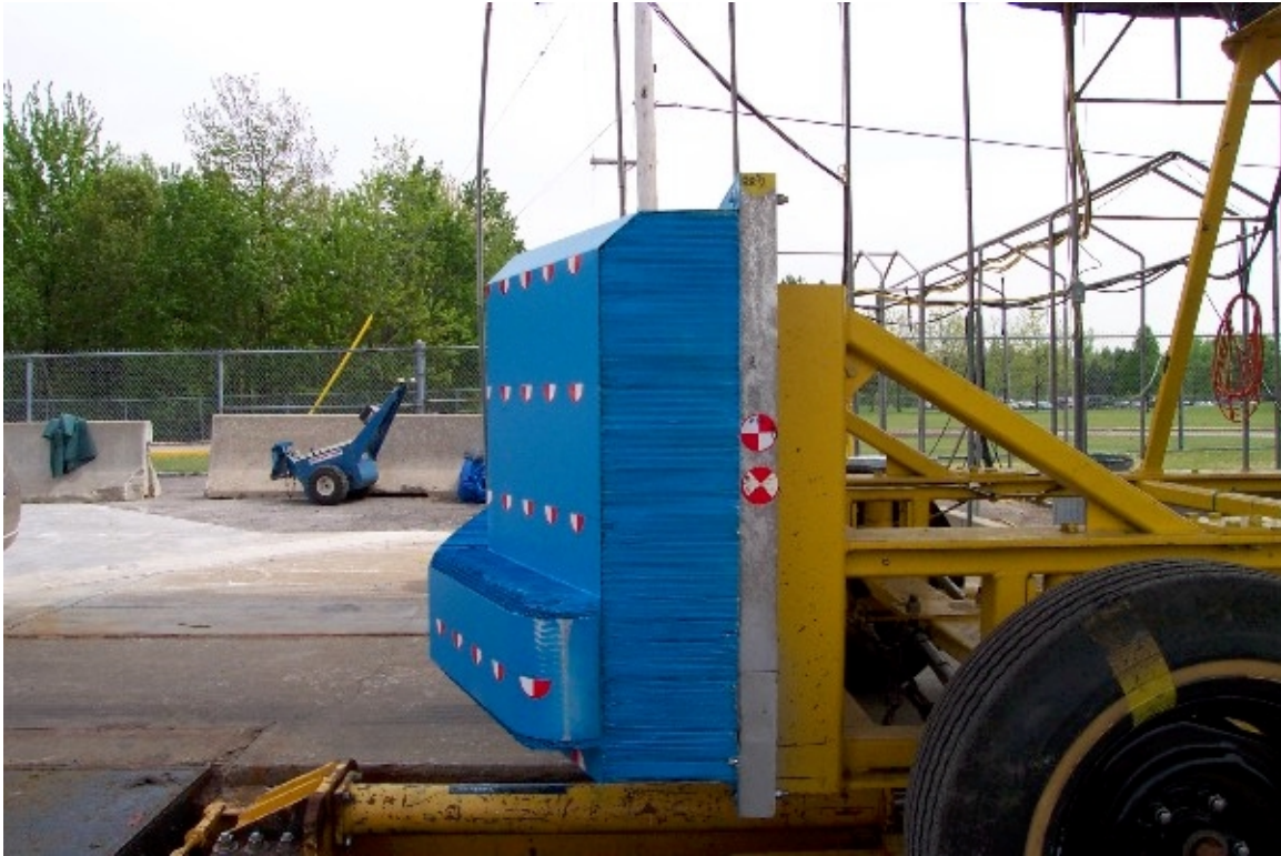
19. Vue du côté gauche de la face déformable, avant essai. Left side view of the deformable face, pre-test.
