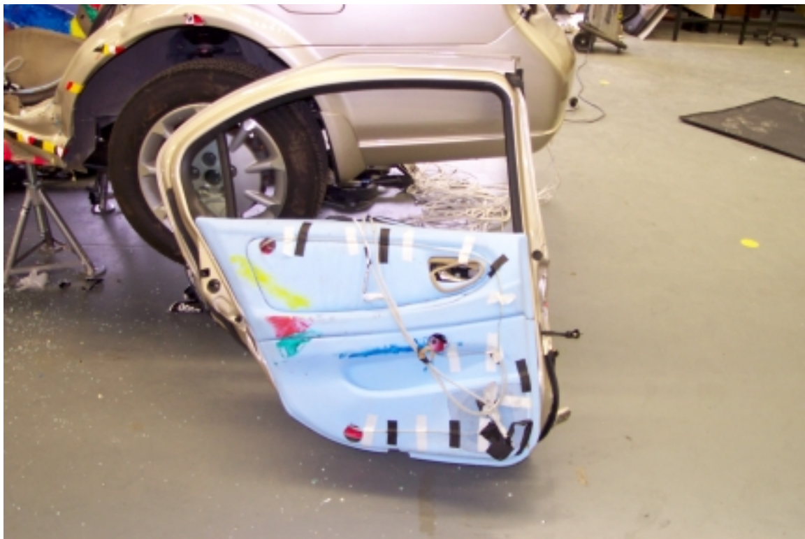
51. Points de contact sur l'intérieur de la portière arrière gauche, après essai. Contact points on the inside of the left rear door trim, post-test .
