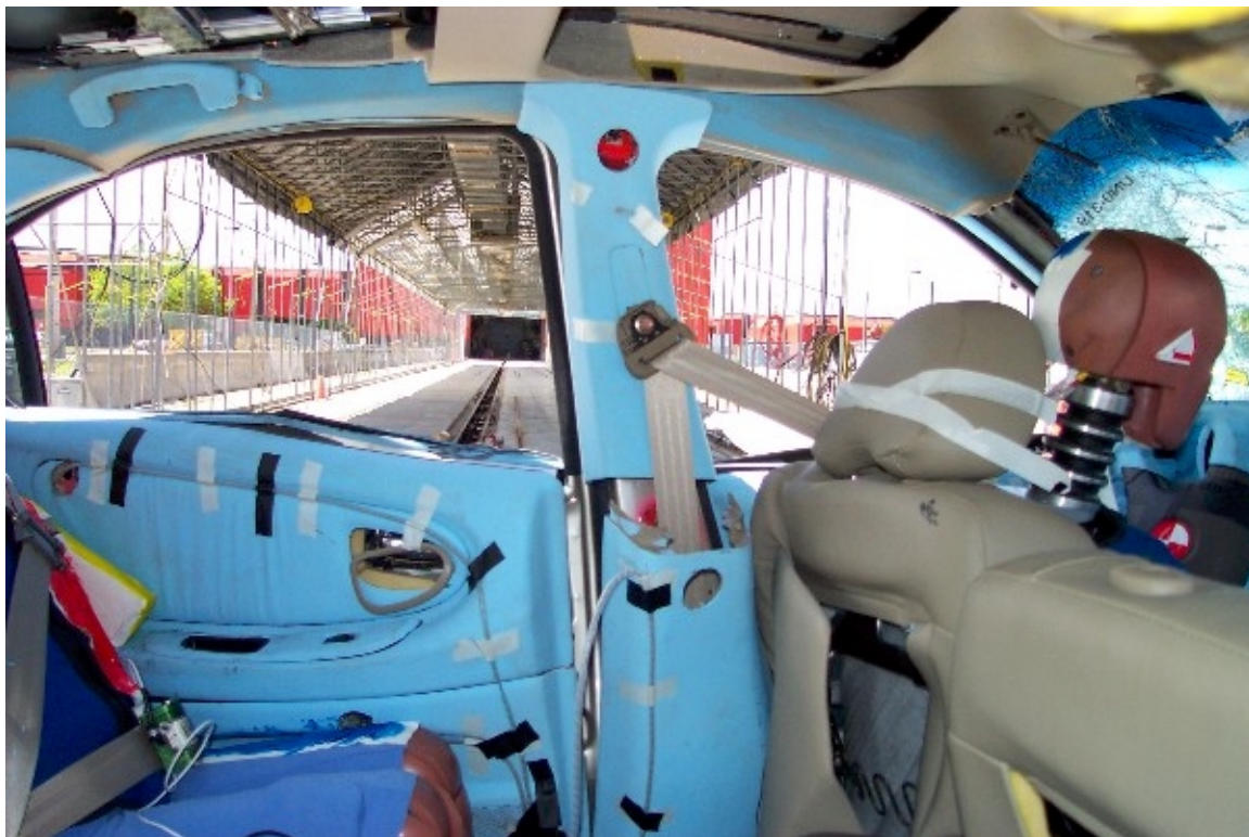
43. Pilier "B" du côté gauche, véhicule cible, après essai. Left side "B" pillar, target vehicle, post-test.
