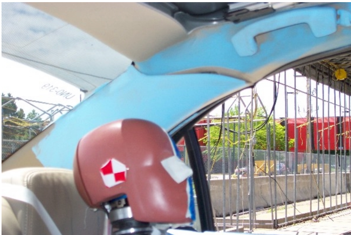
49. Cadre de fenêtre et pilier "C" du côté gauche, véhicule cible, après essai. Window edge and left side "C" pillar, target vehicle, post-test.
