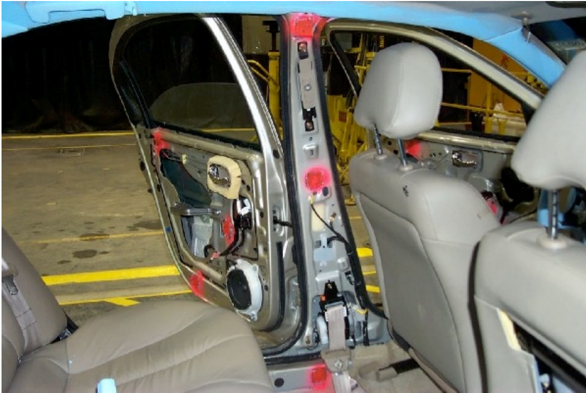
37. Position des accéléromètres sur le pilier "B". Position of accelerometers on "B"pillar.
