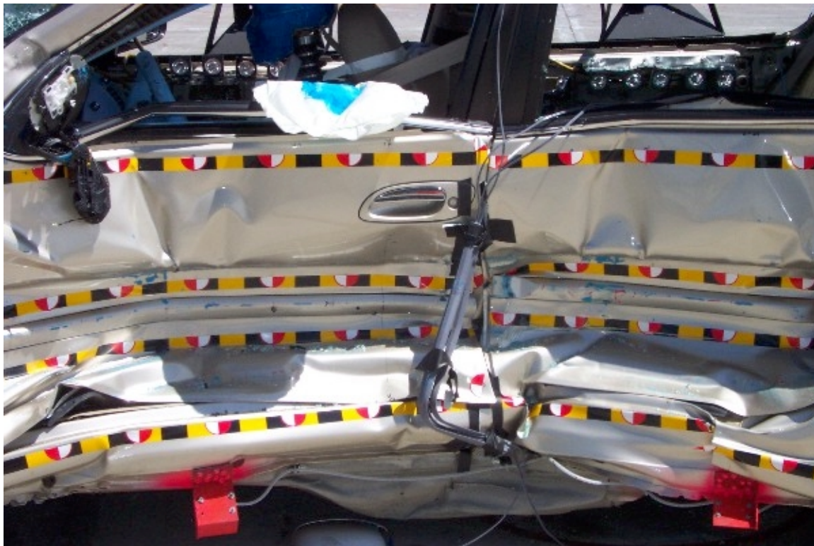
16. Point d'impact sur véhicule cible, après essai. Impact point on target vehicle, post-test.
