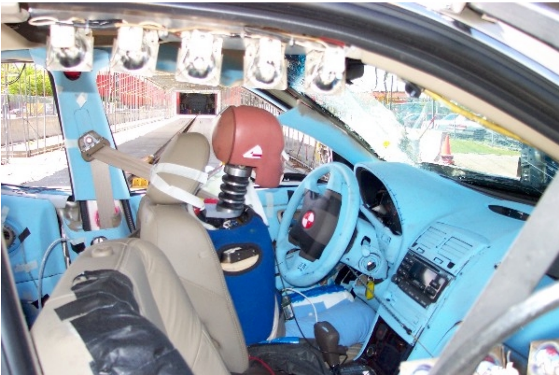
41. Côté droit du conducteur, véhicule cible, après essai. Right side of driver, target vehicle, post-test.
