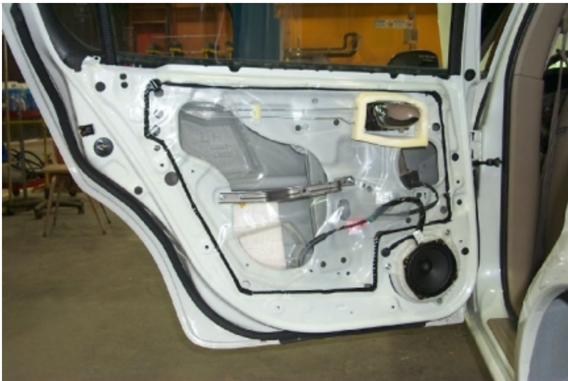
34. Mousse de protection à l'intérieur de la porte arrière gauche. Protective foam inside left rear door.
