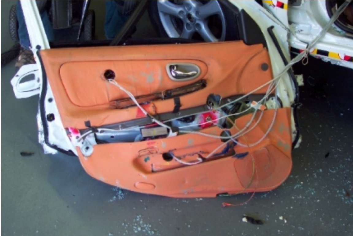
51. Points de contact sur l'intérieur de la portière avant gauche, après essai. Contact points on the inside of the left front door trim, post-test .
