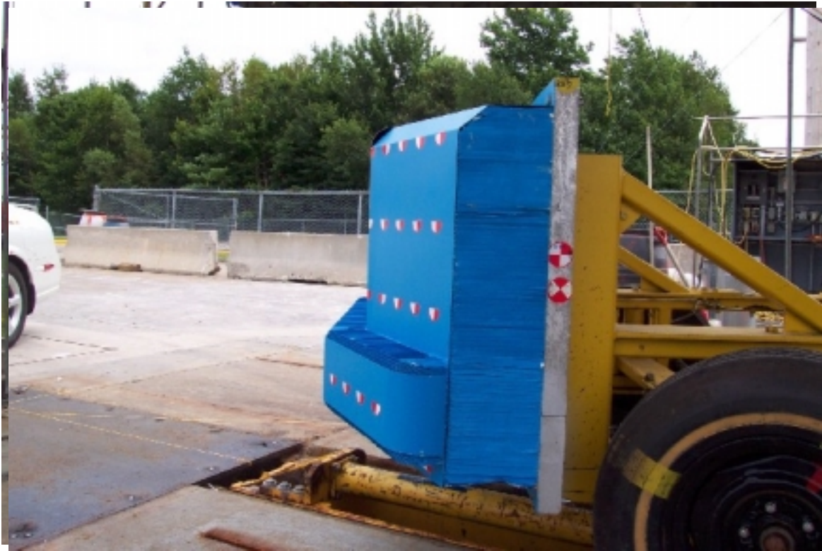
17. Vue de l'avant de la face déformable, avant essai.
