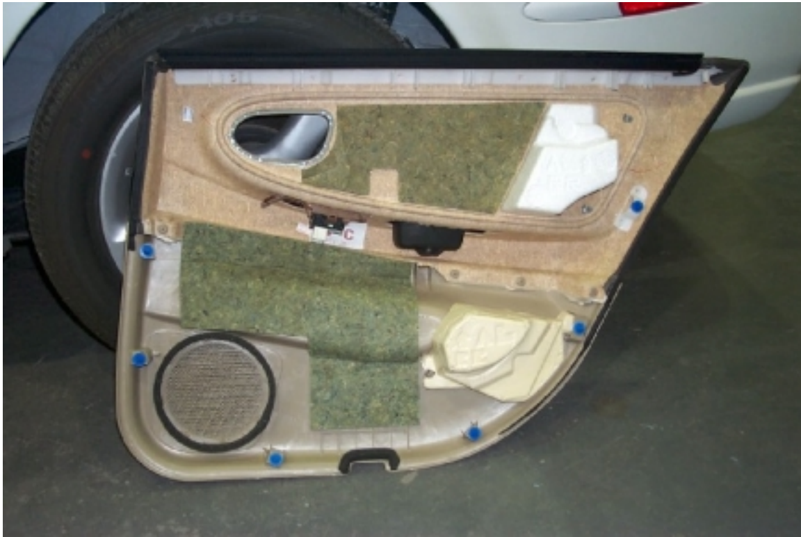
33. Mousse de protection située dans la garniture de la porte arrière gauche. Protective foam located in left rear door trim.
