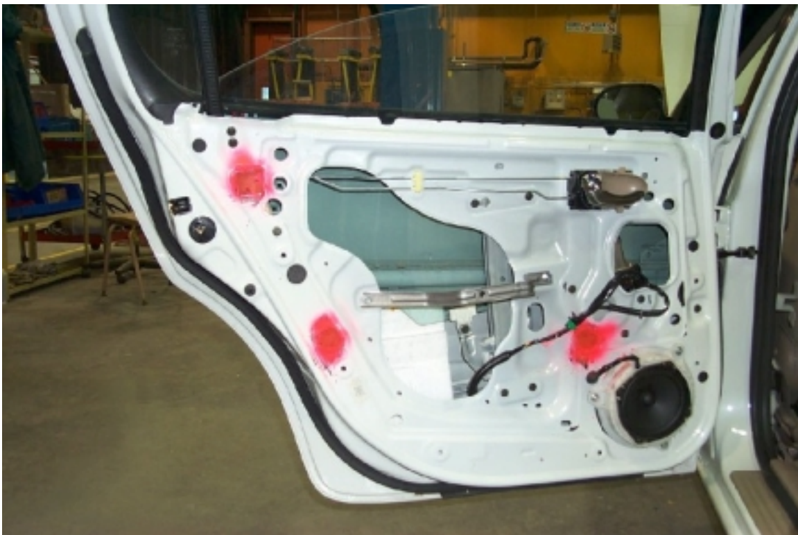
36. Position des accéléromètres dans la porte arrière gauche. Position of accelerometers in rear left door.
