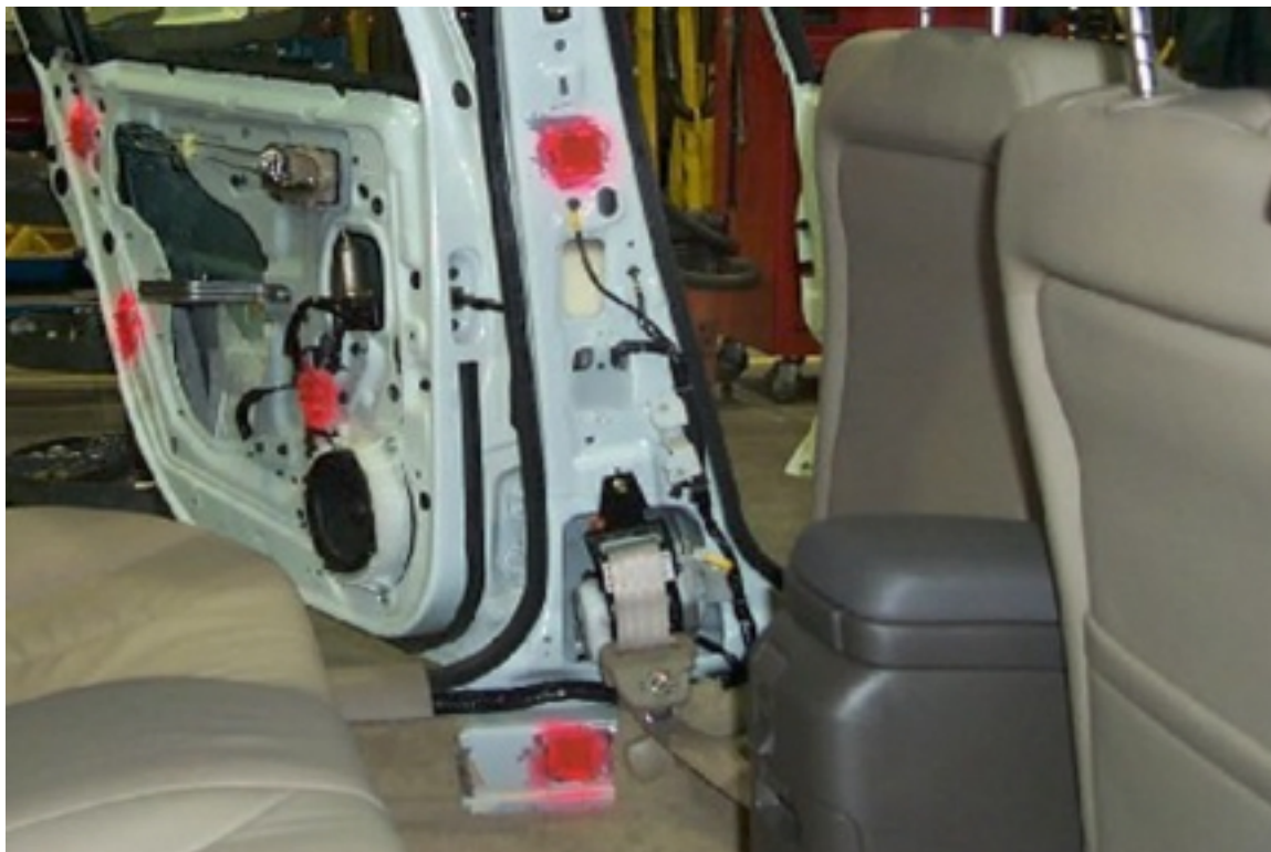
38. Position des accéléromètres sur le pilier "B". Position of accelerometers on "B"pillar.
