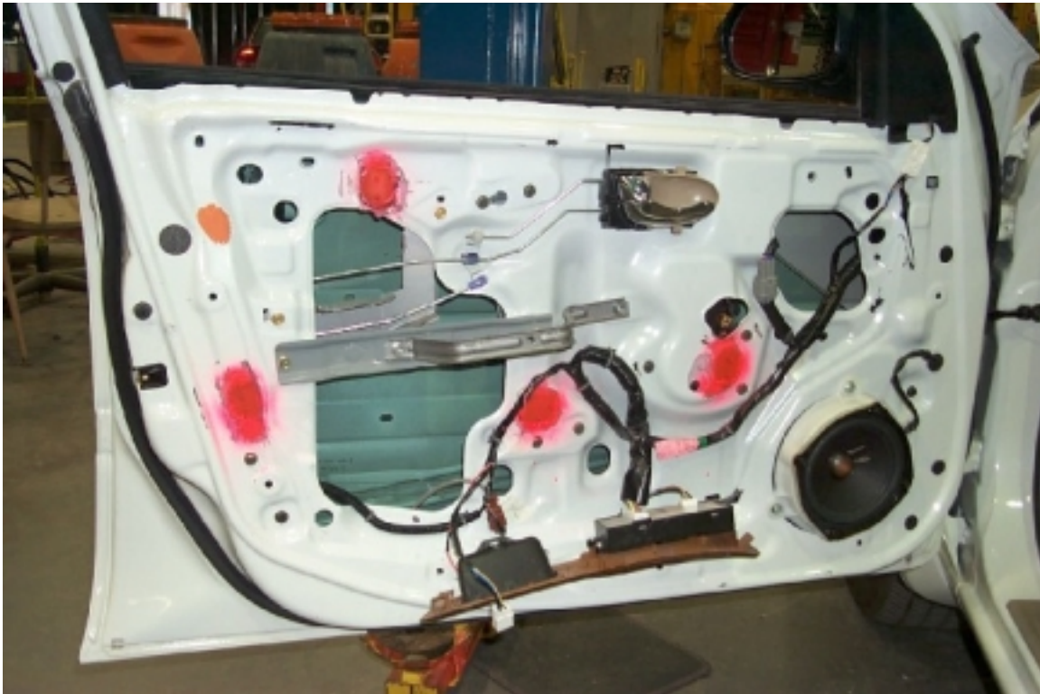
35. Position des accéléromètres dans la porte avant gauche. Position of accelerometers in front left door.
