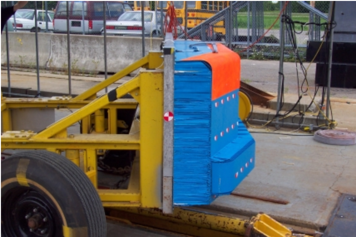
22. Vue du côté droit de la face déformable, après essai. Right side view of the deformable face, post-test.
