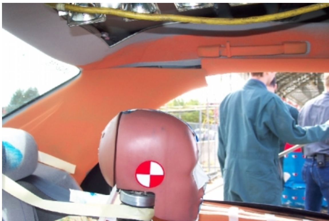
50. Cadre de fenêtre et pilier "C" du côté gauche, véhicule cible, après essai. Window edge and left side "C" pillar, target vehicle, post-test.
