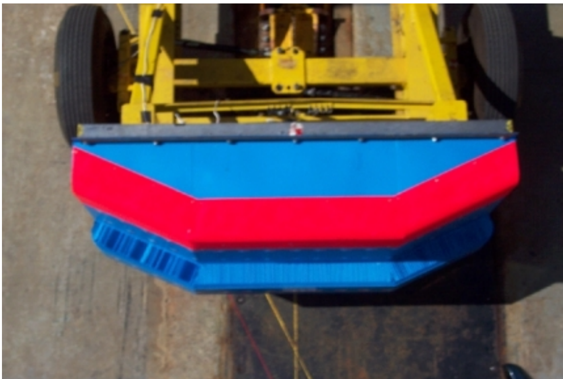
23. Vue de plan de la face déformable, avant essai. Overview of the deformable face, pre-test.
