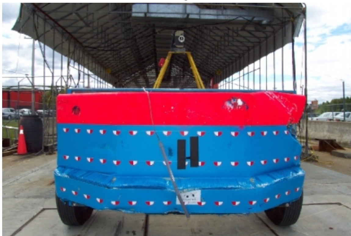
17. Vue de l'avant de la face déformable, avant essai. Front view of the deformable face, pre-test.
