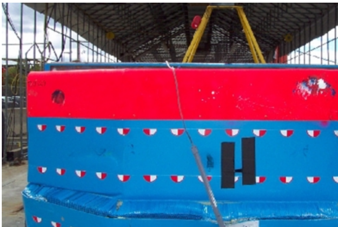
53. Points de contact sur la face déformable, après essai. Contact points on the deformable barrier, post-test
