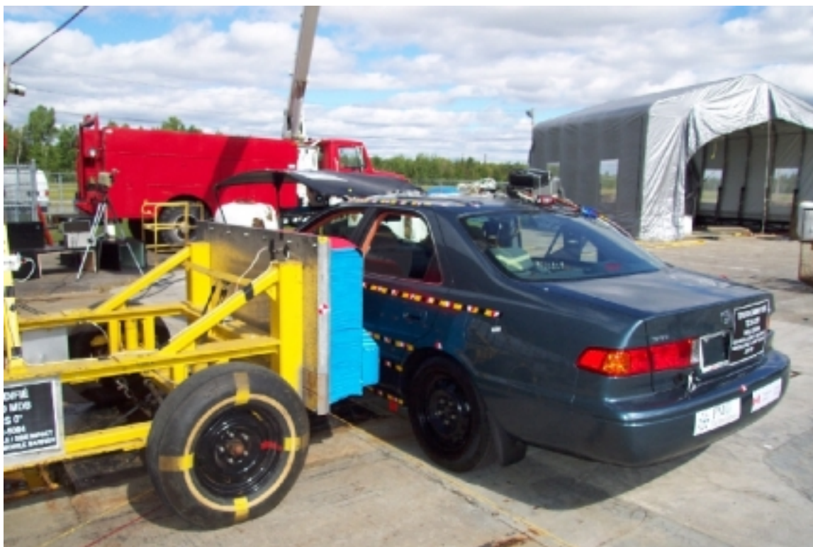
27. Vue \frac{3}{4} arrière des véhicules en contact, avant essai. \frac{3}{4} front view of vehicles in contact, pre-test.
