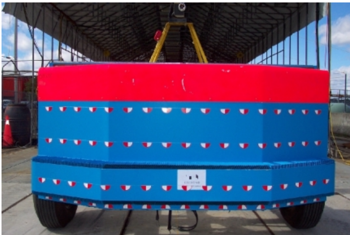
17. Vue de l'avant de la face déformable, avant essai. Front view of the deformable face, pre-test.
