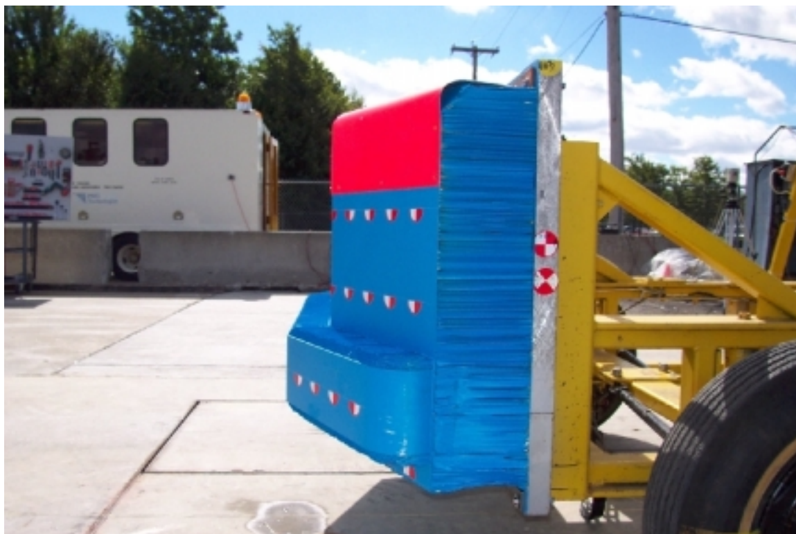
21. Vue du côté droit de la face déformable, avant essai. Right side view of the deformable face, pre-test.
