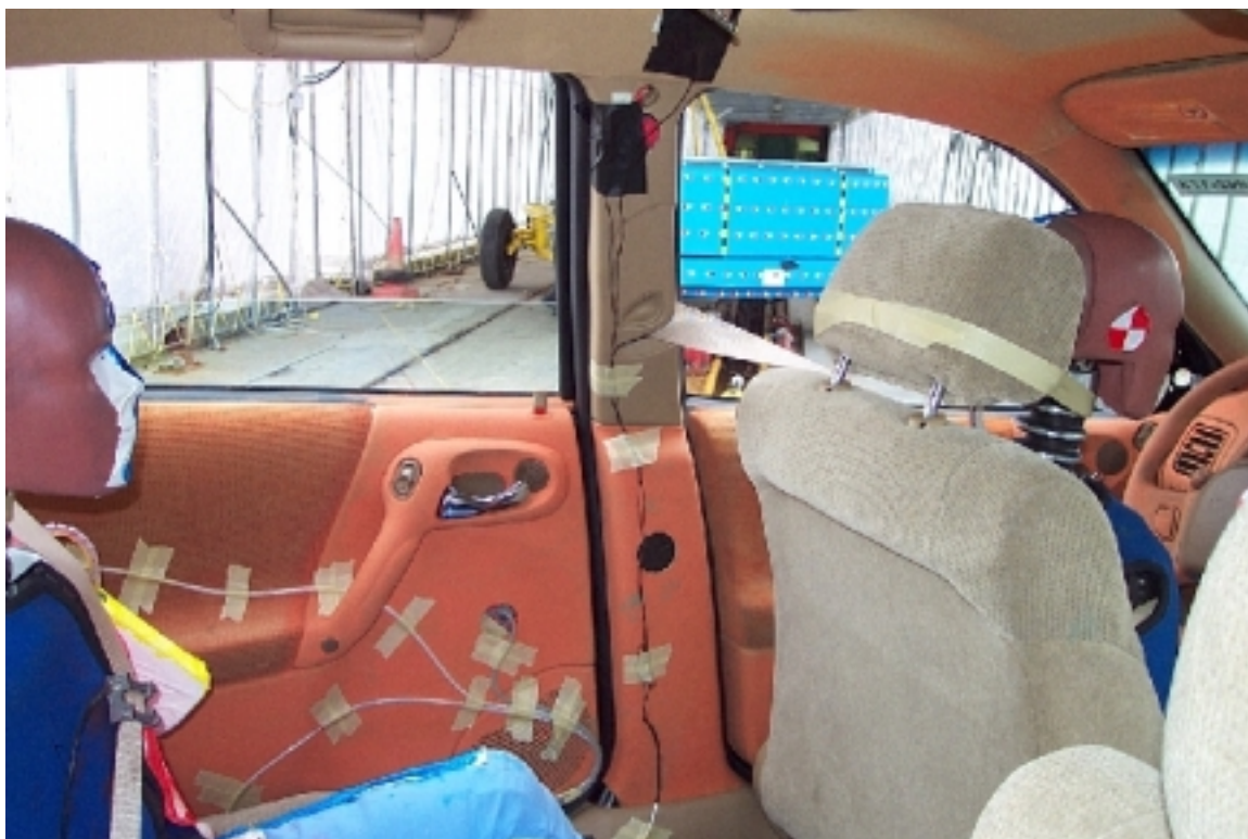
43. Pilier "B" du côté gauche, véhicule cible, avant essai. Left side "B" pillar, target vehicle, pre-test.
