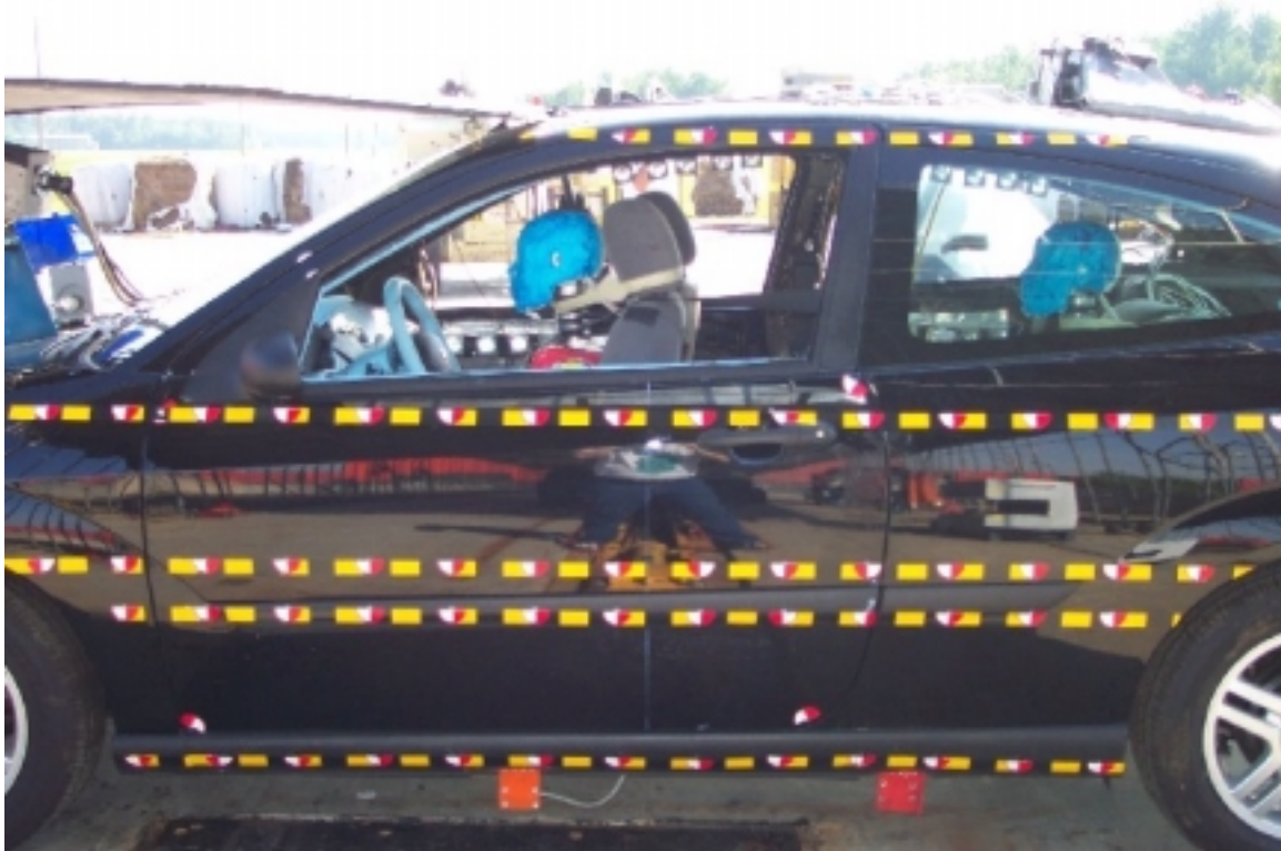
13. Surface ciblée côté gauche du véhicule cible, avant essai. Targets on left side of target vehicle, pre-test.
