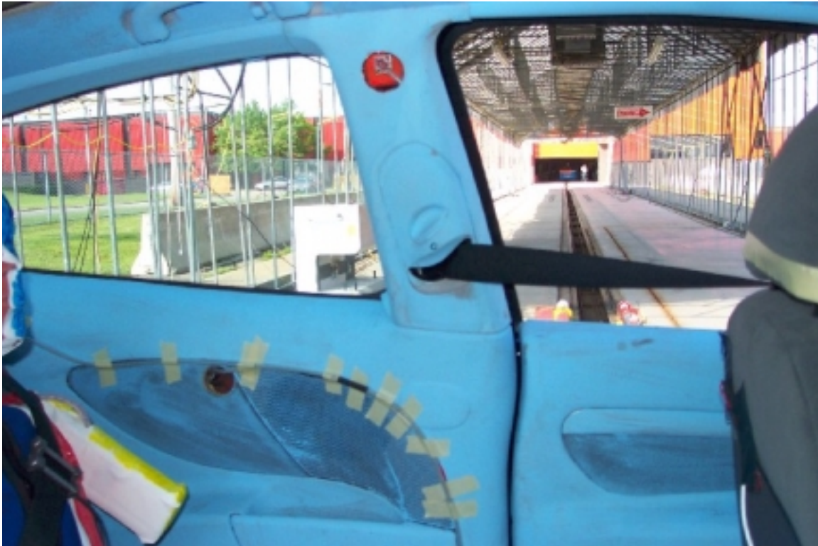
39. Pilier "B" du côté gauche, véhicule cible, avant essai. Left side "B" pillar, target vehicle, pre-test.
