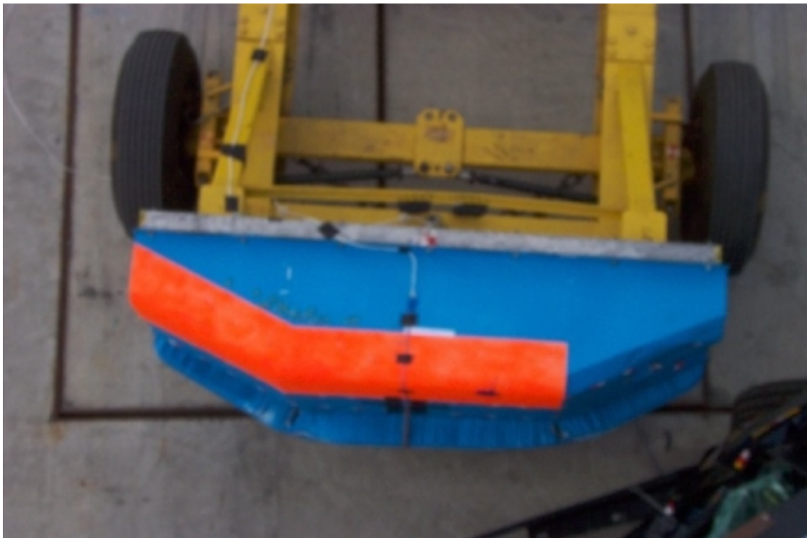
24. Vue de plan de la face déformable, après essai. Overview of the deformable face, post-test.
