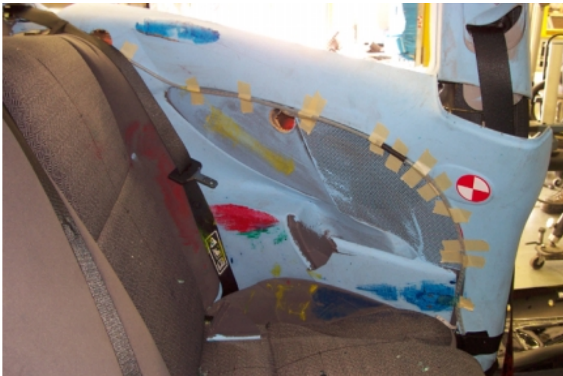
48. Points de contact sur l'intérieur arrière gauche, après essai. Contact points on the inside of the left rear trim, post-test .
