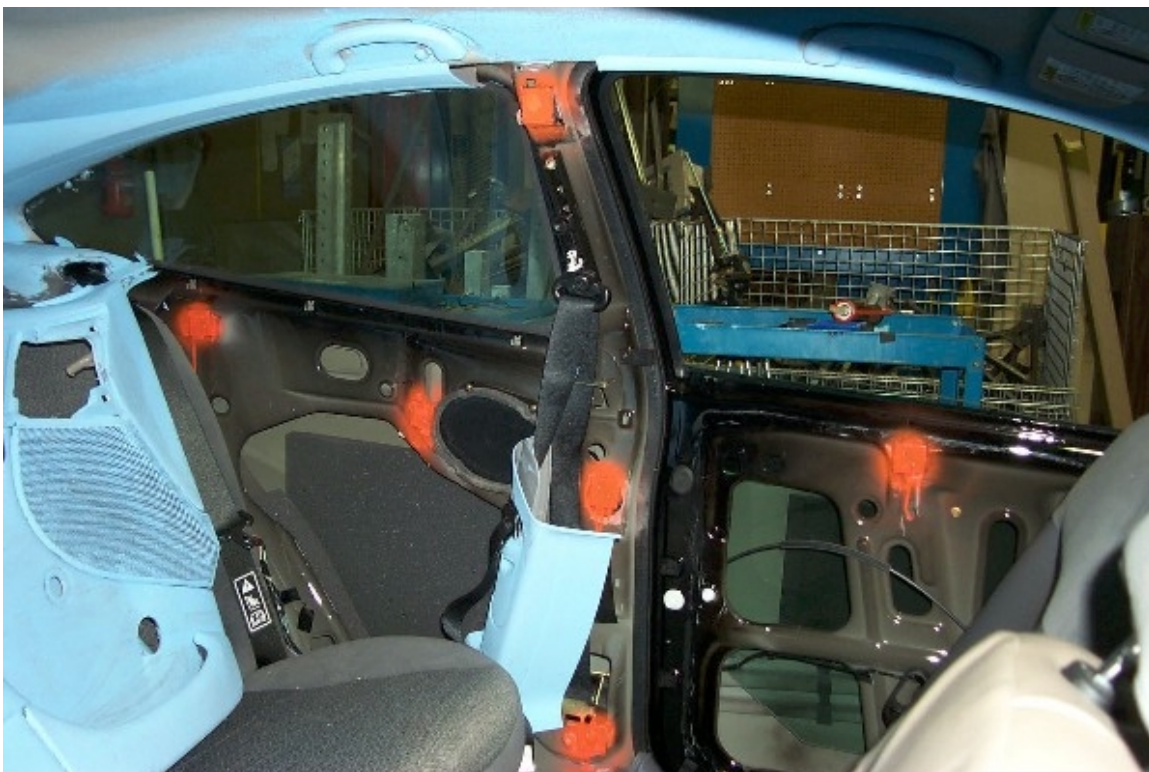
34. Position des accéléromètres sur le pilier "B". Position of accelerometers on "B" pillar.
