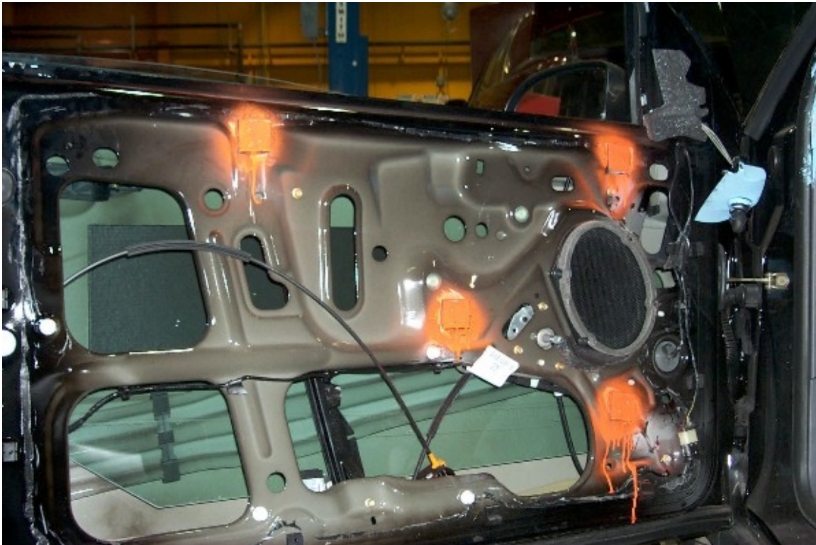
33. Position des accéléromètres dans la porte avant gauche. Position of accelerometers in front left door.
