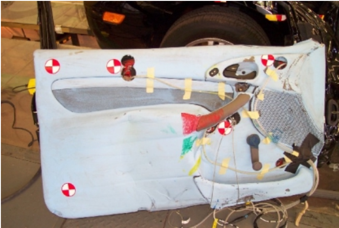
47. Points de contact sur l'intérieur de la portière avant gauche, après essai. Contact points on the inside of the left front door trim, post-test .
