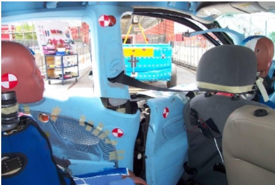
40. Pilier "B" du côté gauche, véhicule cible, après essai. Left side "B" pillar, target vehicle, post-test.
