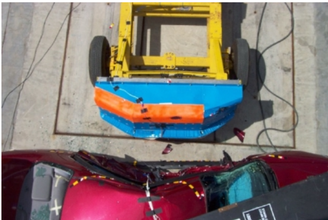
30. Vue de plan des véhicules en contact, après essai. Top view of vehicles in contact, post-test.
