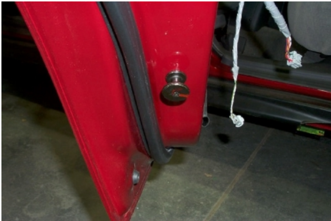
35. Loquet supplémentaire de la porte arrière gauche, avant essai. Additional latch of left rear door, pre-test.
