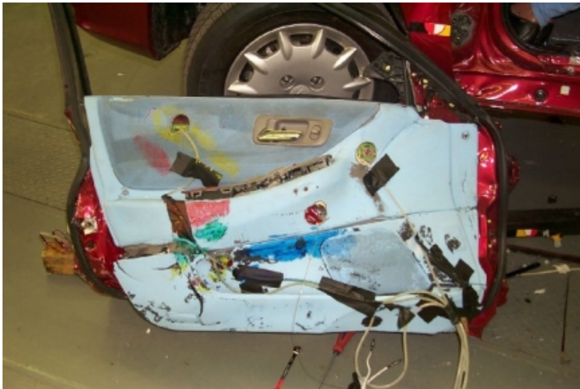
53. Points de contact sur l'intérieur de la portière avant gauche, après essai. Contact points on the inside of the left front door trim, post-test .
