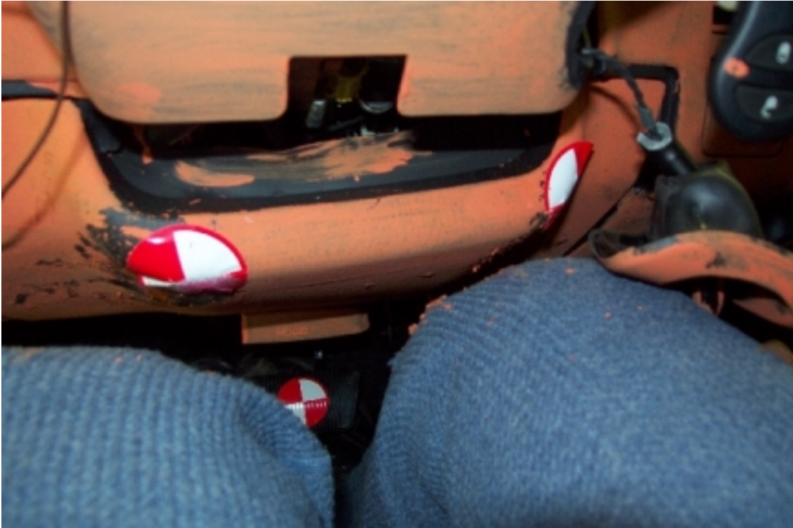
25. Point de contact des genoux du conducteur, après essai. Driver's knees contact point, post-test.
