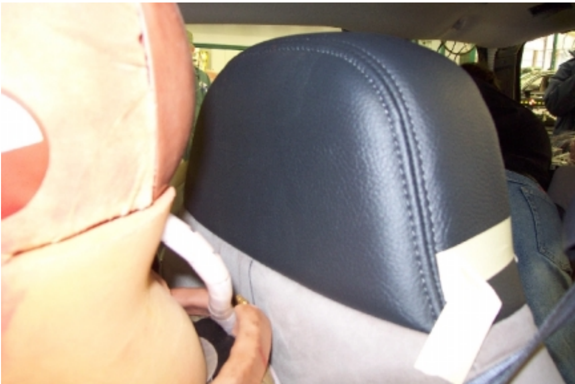
24. Point de contact de tête du conducteur, après essai. Driver's head contact point, post-test.
