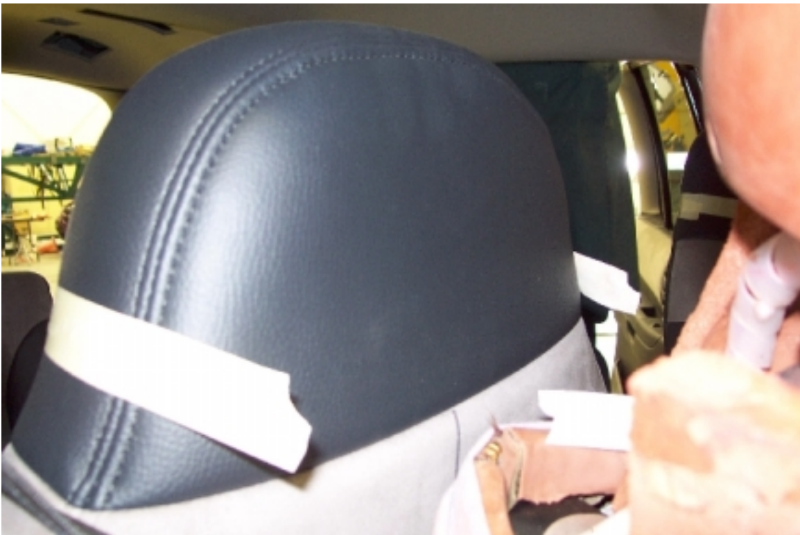
29. Point de contact de tête du passager, après essai. Passenger's head contact point, post-test.
