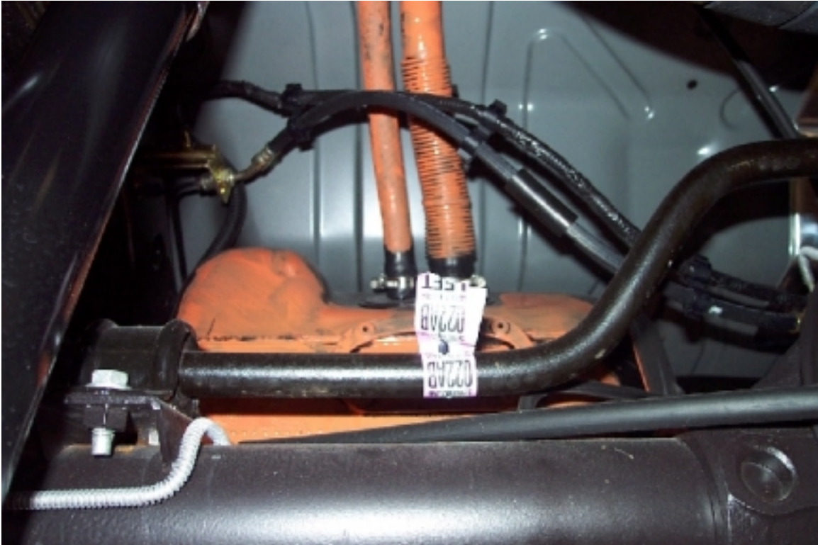
37. Ligne de carburant et vapeur. Fuel and vapor lines.
