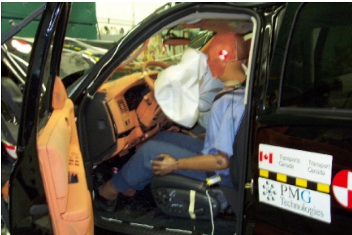
22. Position du conducteur, après essai. Driver's position, post-test.
