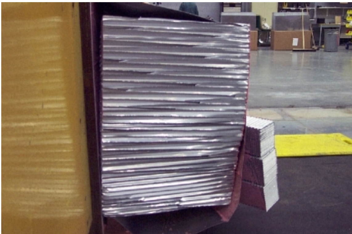
26. Vue du côté gauche de la face déformable, après essai. Left side view of the deformable face, post-test.
