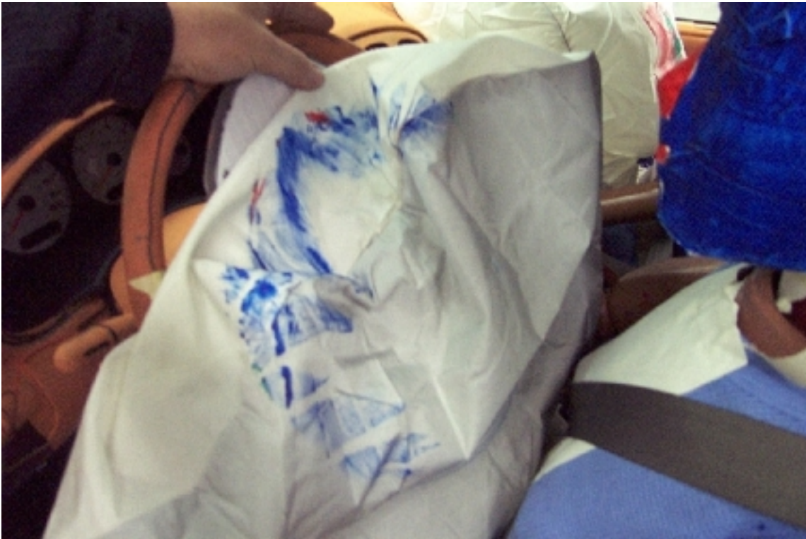
35. Point de contact de tête du conducteur, après essai. Driver's head contact point, post-test.
