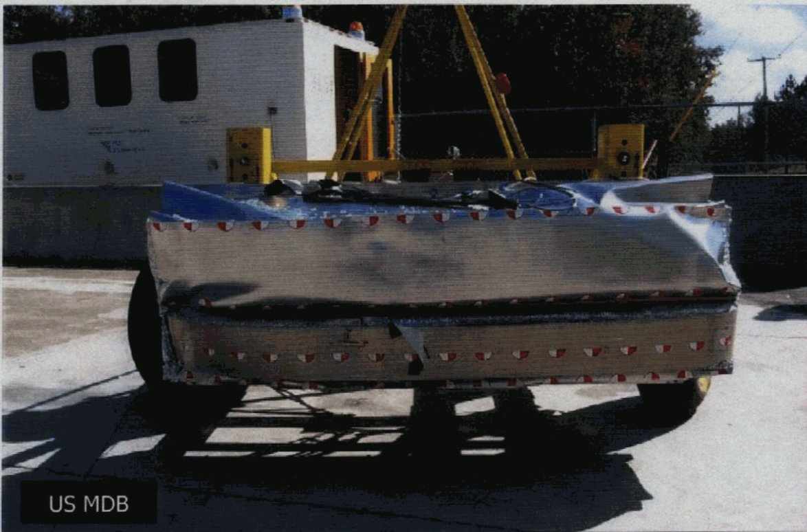
18. Vue de l'avant de la face déformable, après essai. Front view of the deformable face, post-test.
