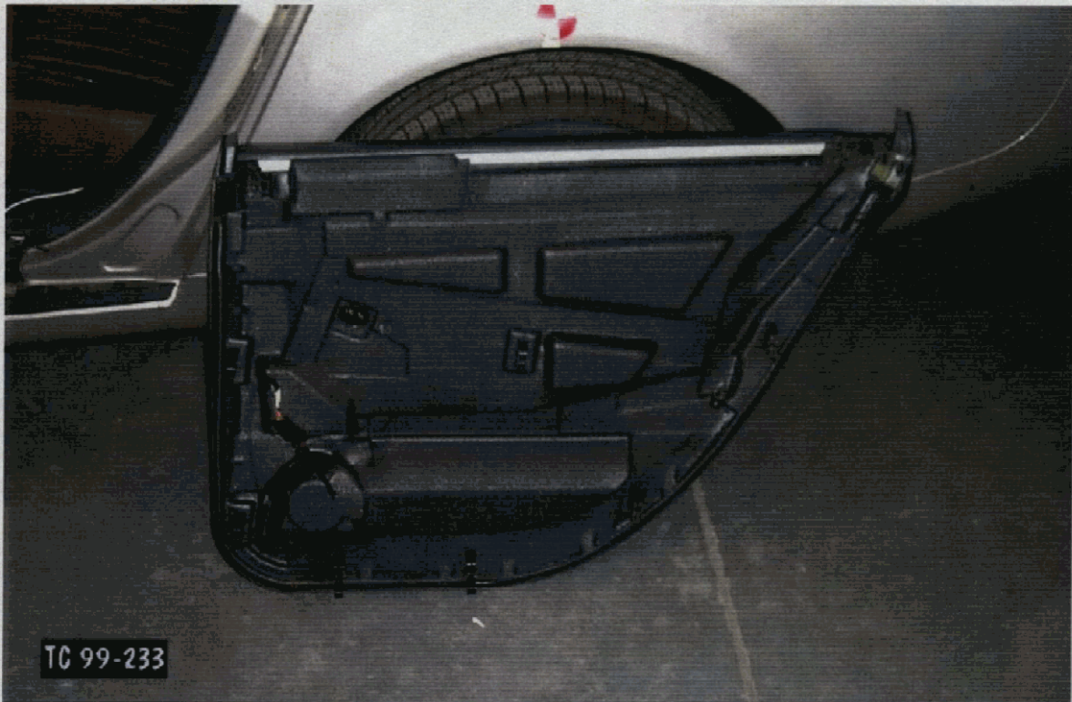
34. Mousse de protection située dans la garniture de la porte arrière gauche. Protective foam located in left rear door trim.
