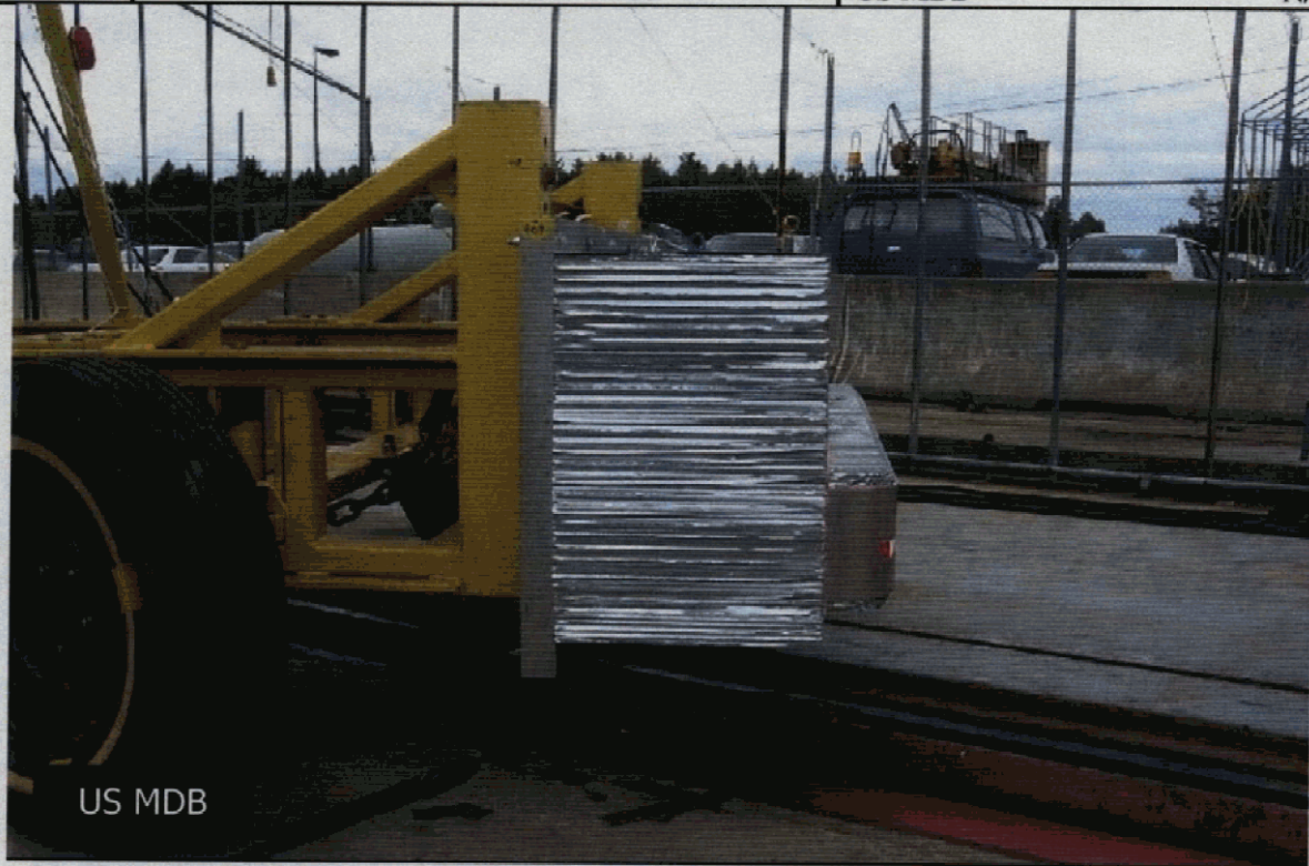
21. Vue du côté droit de la face déformable, avant essai. Right side view of the deformable face, pre-test.
