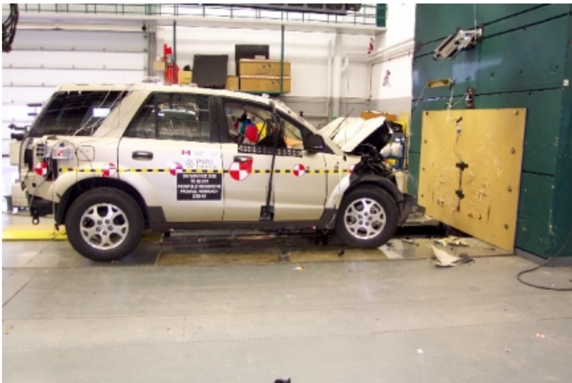
10. Vue générale côté droit du véhicule d'essai, après essai. General right side view of the test vehicle, post-test.
