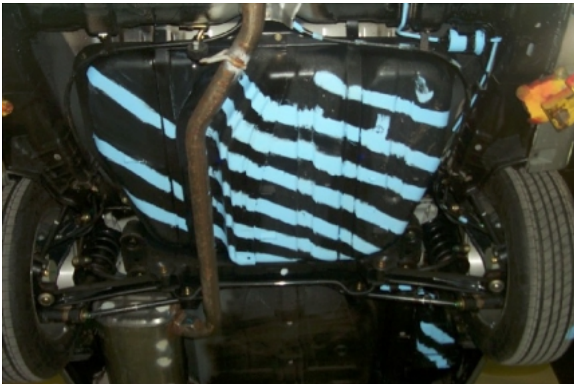
36. Réservoir de carburant. Fuel tank.
