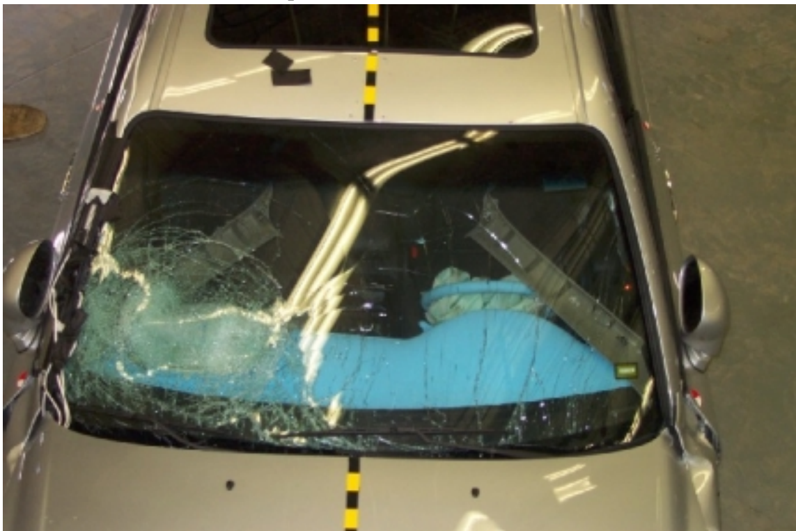
22. Pare-brise, après essai. Windshield, post-test.
