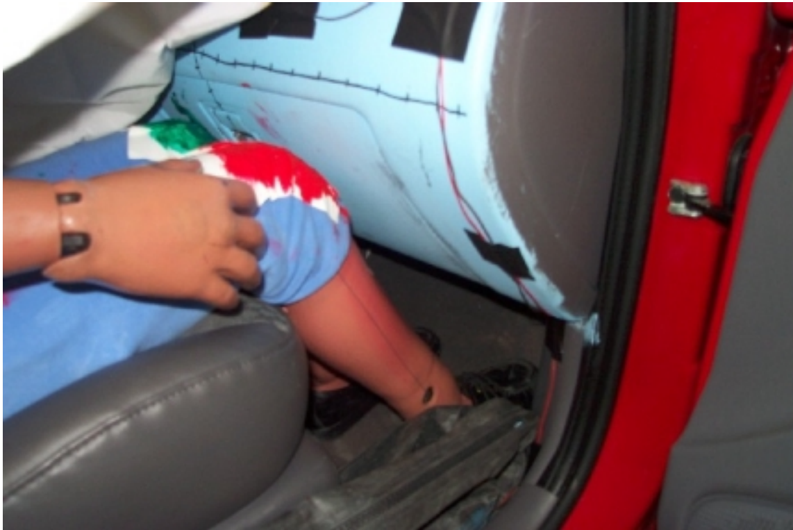
40. Point de contact des genoux du passager, après essai. Passenger's knee contact points, post-test.
