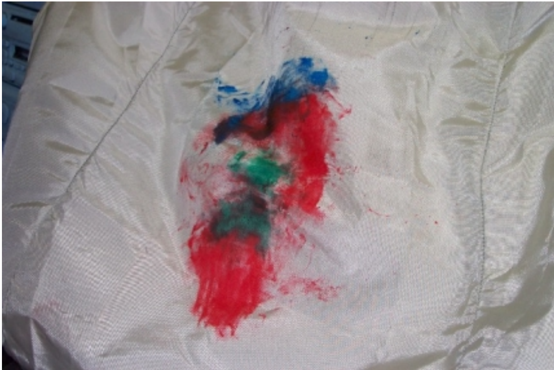
38. Point de contact de tête du passager, après essai. Passenger's head contact point, post-test.
