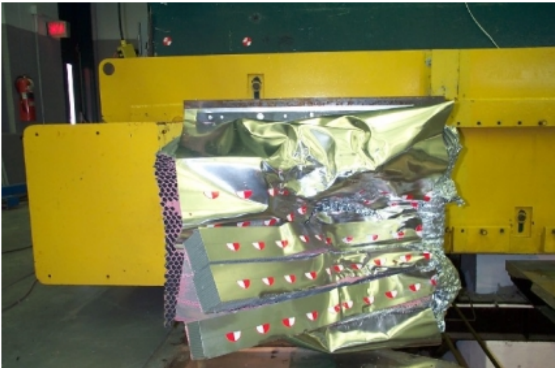
30. Vue de face de la face déformable, après essai. Front view of the deformable face, post-test.
