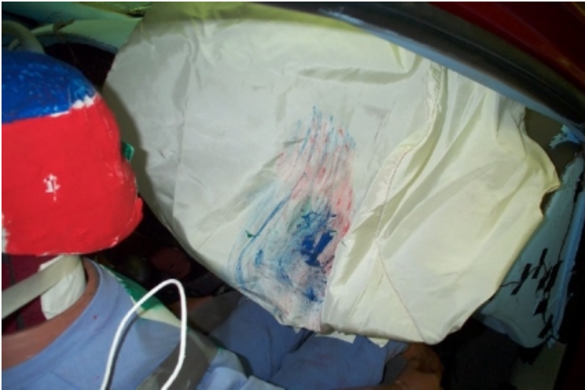
40. Point de contact de tête du passager, après essai. Passenger's head contact point, post-test.
