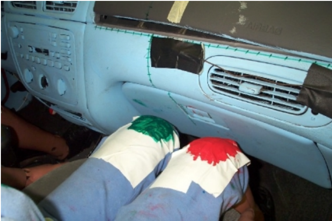
42. Point de contact des genoux du passager, après essai. Passenger's knee contact points, post-test.
