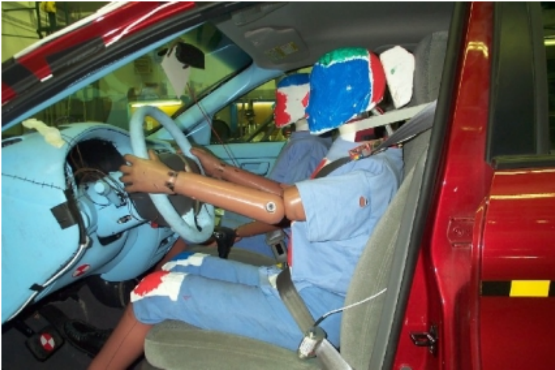
33. Position du conducteur, avant essai. Driver's position, pre-test.
