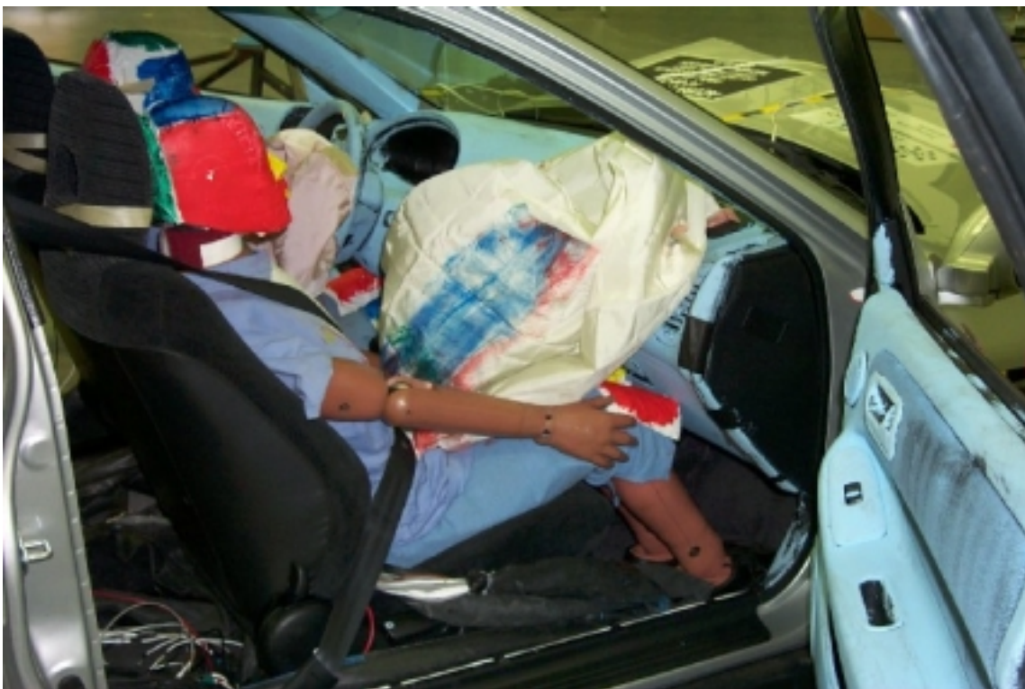
39. Position du passager, après essai. Passenger's position, post-test.
