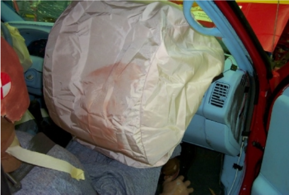
36. Point de contact de tête du passager, après essai. Passenger's head contact point, post-test.
