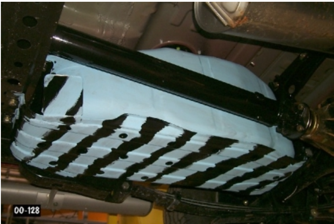
40. Réservoir de carburant. Fuel tank.
