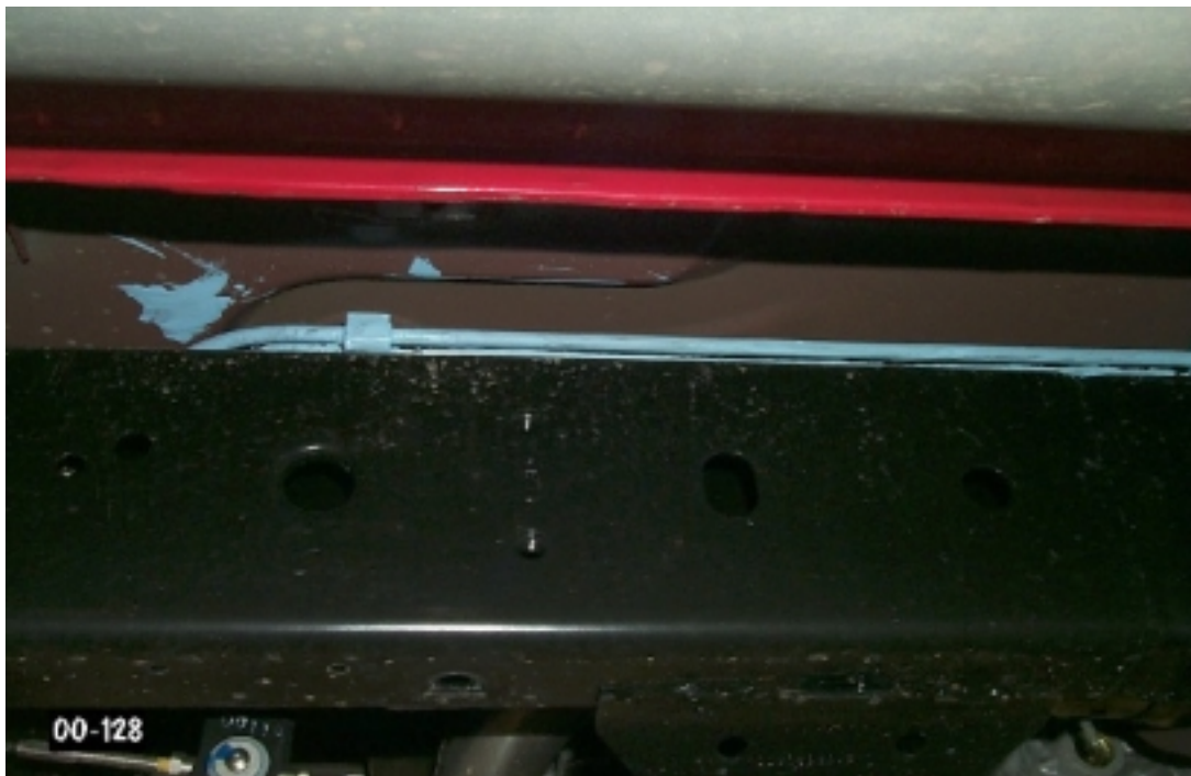
42. Lignes de carburant et vapeur. Fuel and vapor lines.
