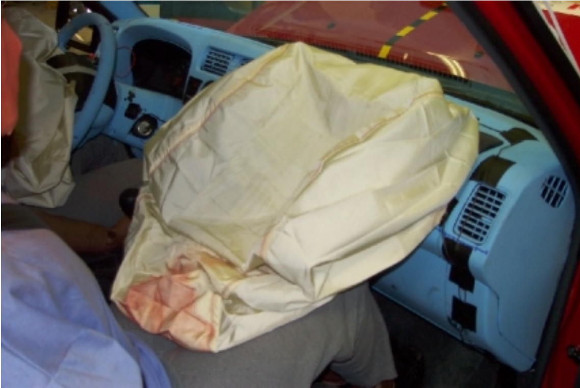
32. Point de contact de tête du passager, après essai. Passenger's head contact point, post-test.
