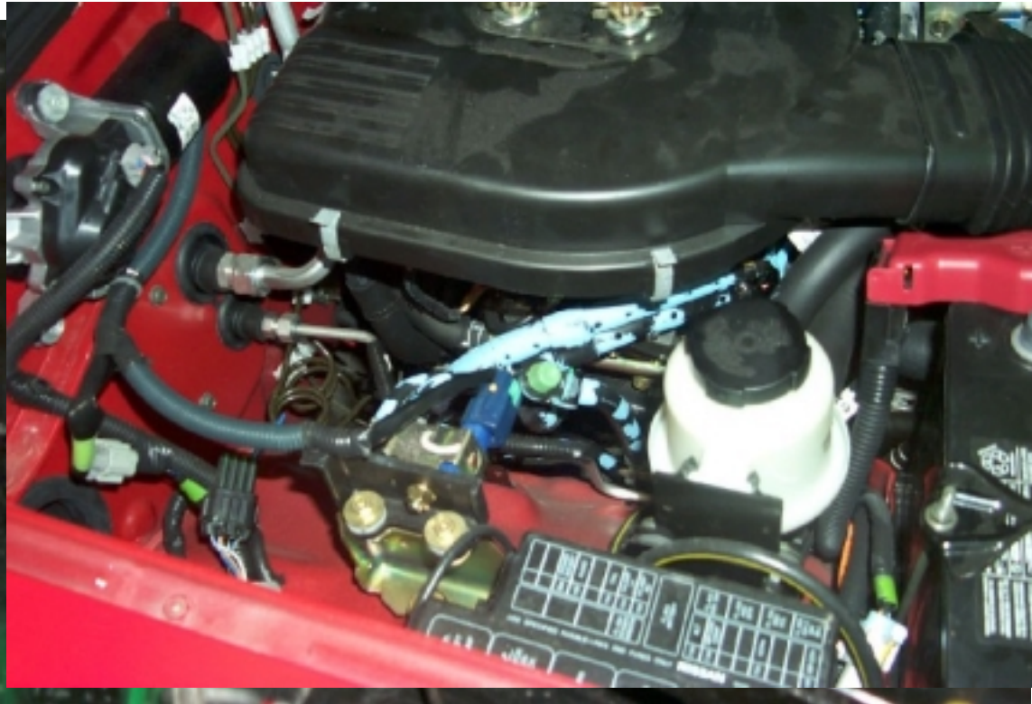
39. Lignes de carburant et vapeur dans le compartiment moteur. Filler and vapor lines in the engine compartment.
