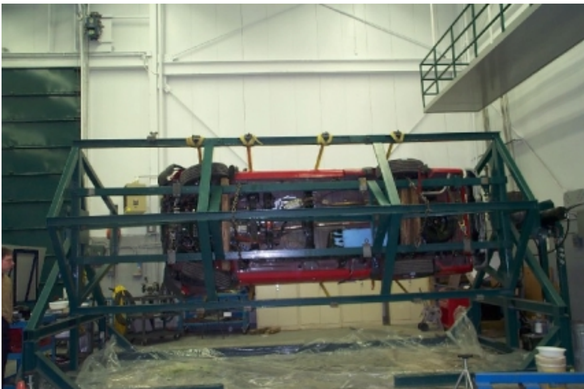
42. Vue du véhicule sur culbuteur à 90°. View of the vehicle on the roll over device at 90°.
