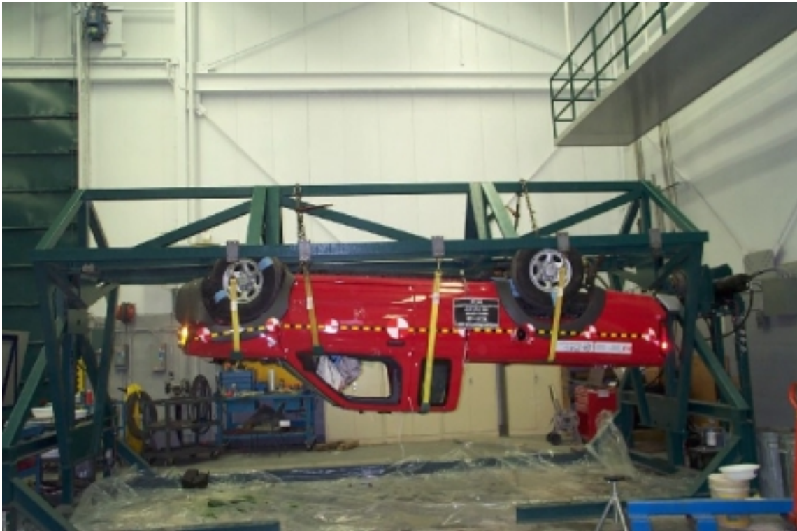
43. Vue du véhicule sur culbuteur à 180°. View of the vehicle on the roll over device at 180°.
