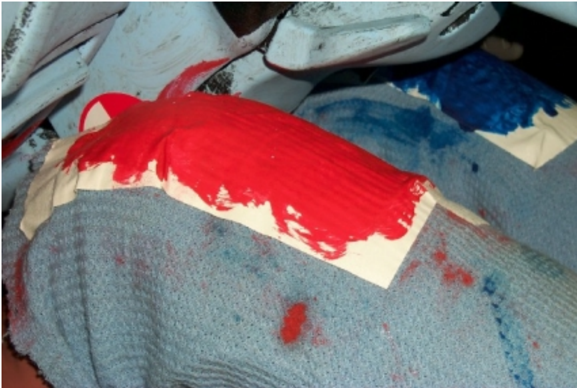
37. Point de contact des genoux du conducteur, après essai. Driver's knee contact points, post-test.
