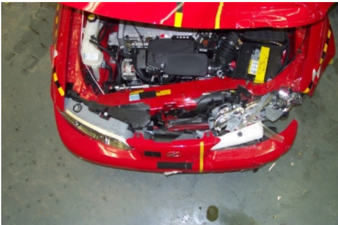
22. Vue du compartiment moteur du véhicule d'essai, après essai. Engine compartment view of the test vehicle, post-test.
