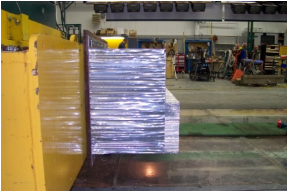
25. Vue du côté gauche de la face déformable, avant essai. Left side view of the deformable face, pre-test.
