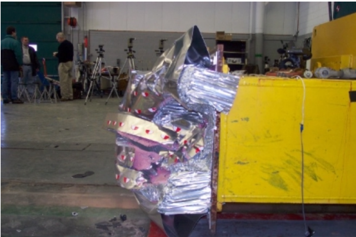
28. Vue du côté droit de la face déformable, après essai. Right side view of the deformable face, post-test.
