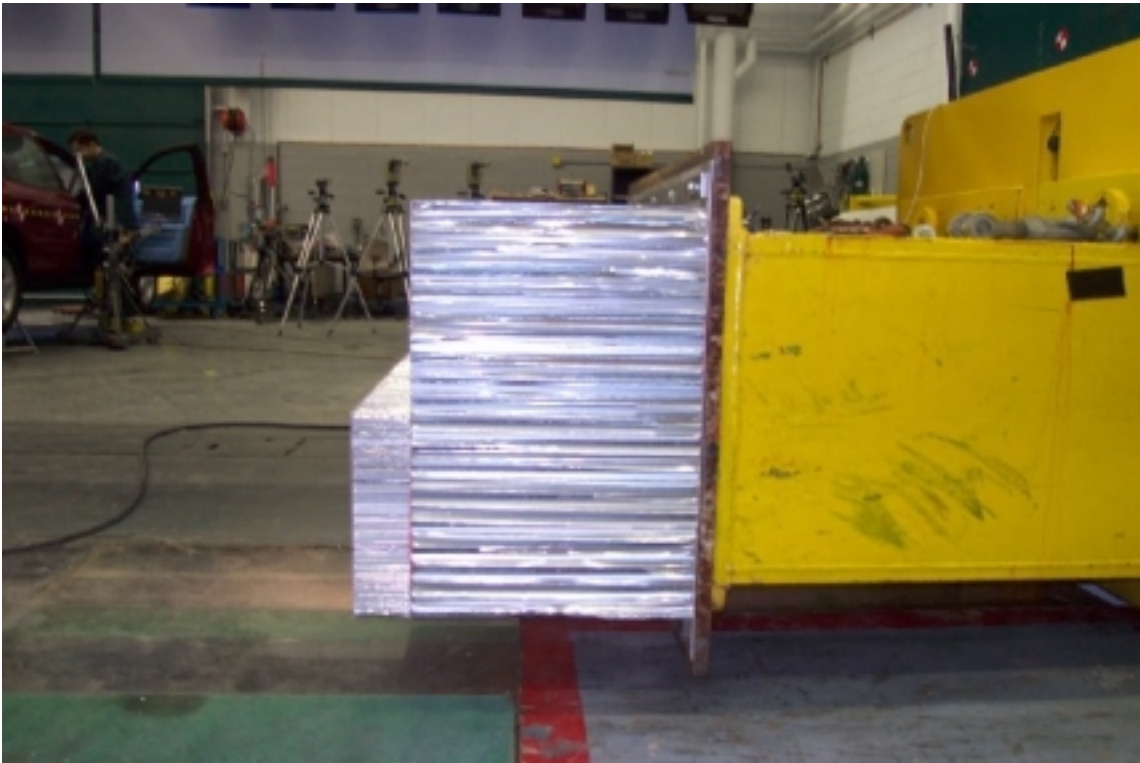
27. Vue du côté droit de la face déformable, avant essai. Right side view of the deformable face, pre-test.
