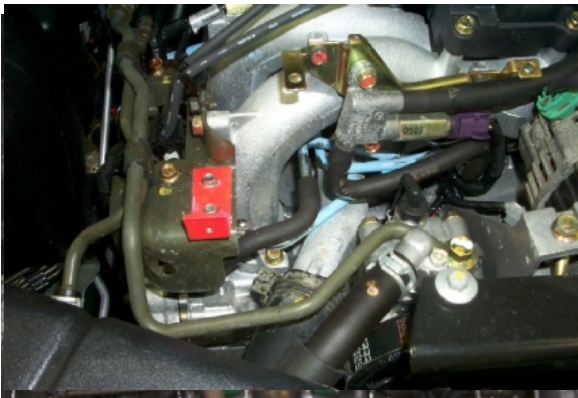
39. Lignes de carburant et vapeur dans le compartiment moteur. Filler and vapor lines in the engine compartment.
