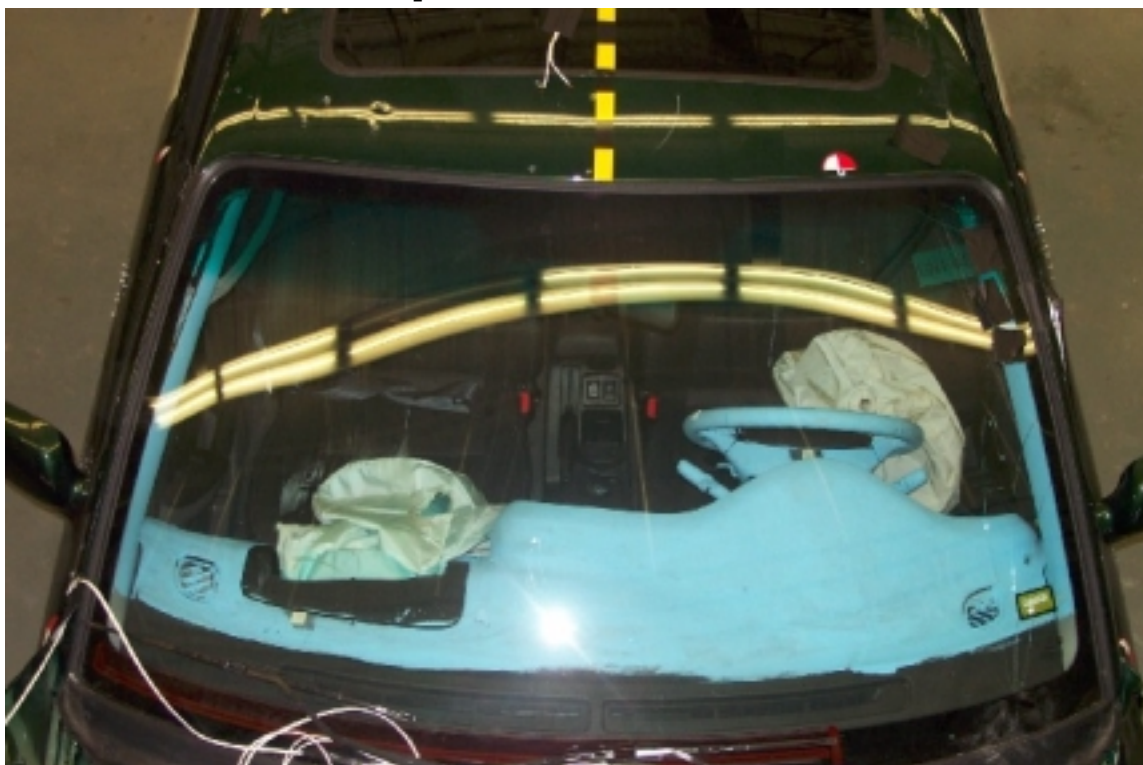
22. Pare-brise, après essai. Windshield, post-test.
