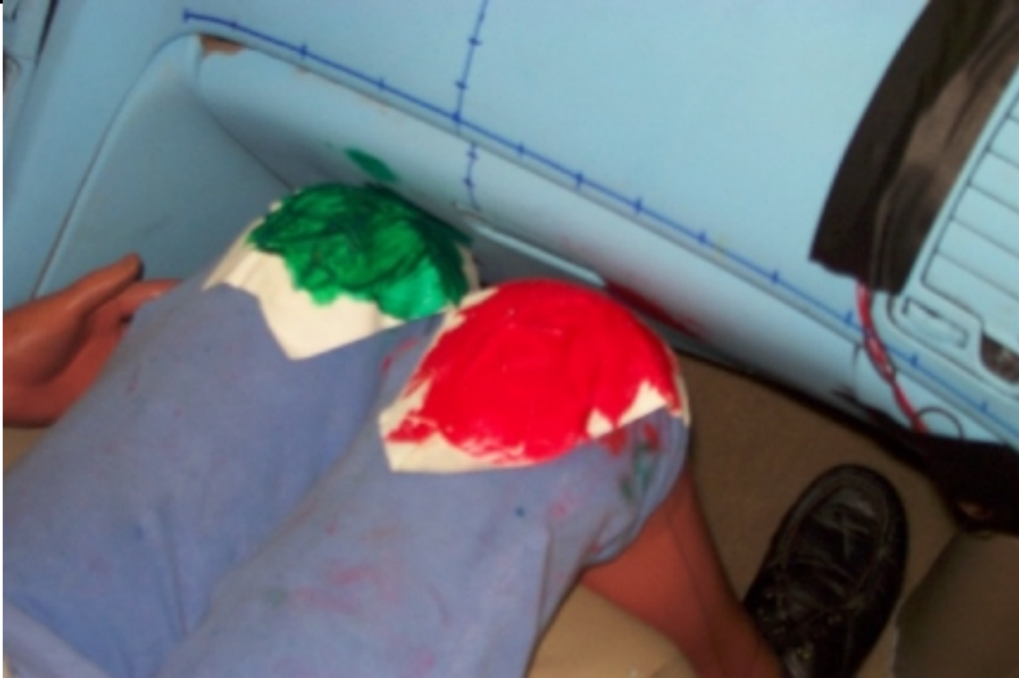
30. Point de contact des genoux du passager, après essai. Passenger's knee contact points, post-test.
