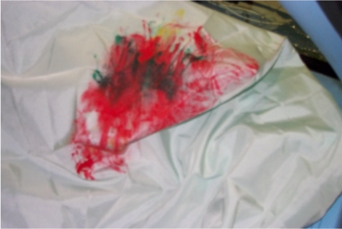
28. Point de contact de tête du passager, après essai. Passenger's head contact point, post-test.
