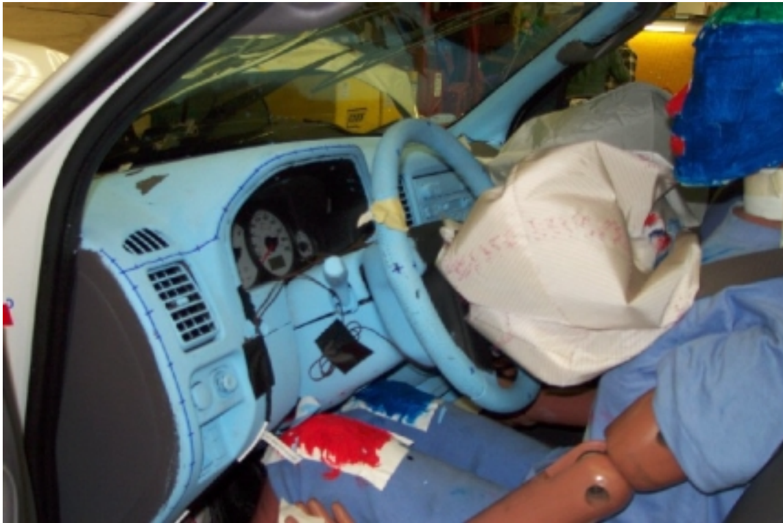
25. Point de contact des genoux du conducteur, après essai. Driver's knee contact points, post-test.
