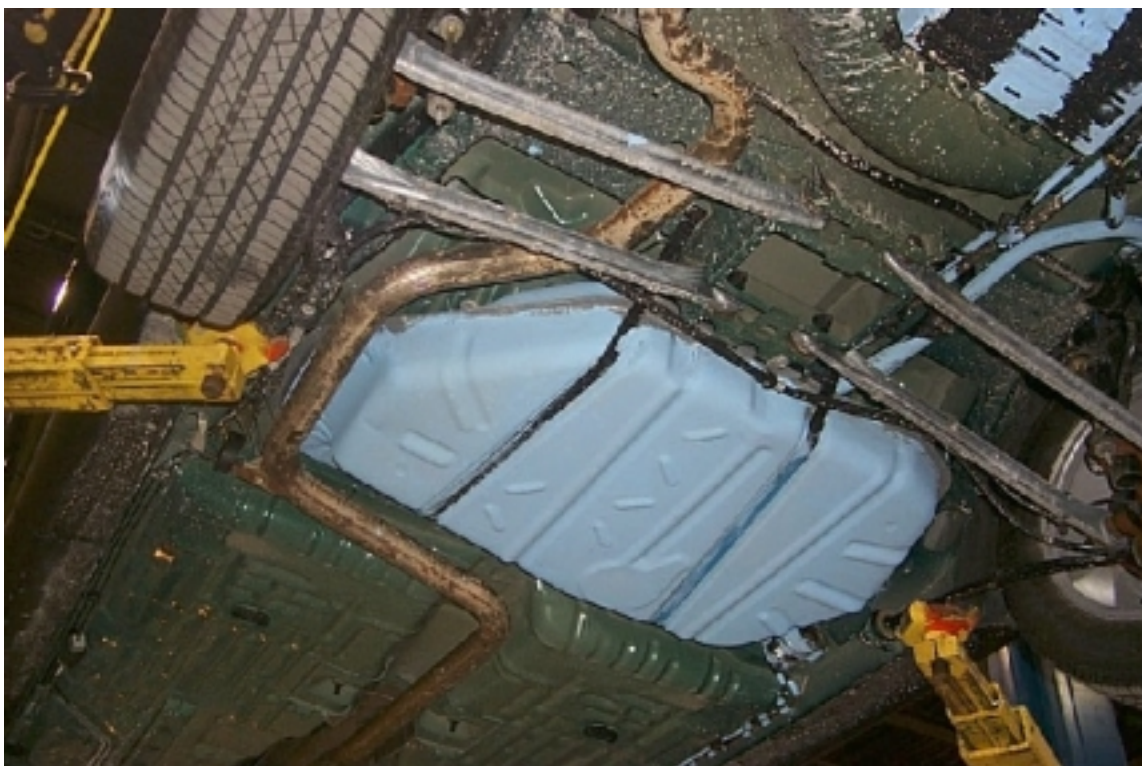
40. Réservoir de carburant. Fuel tank.
