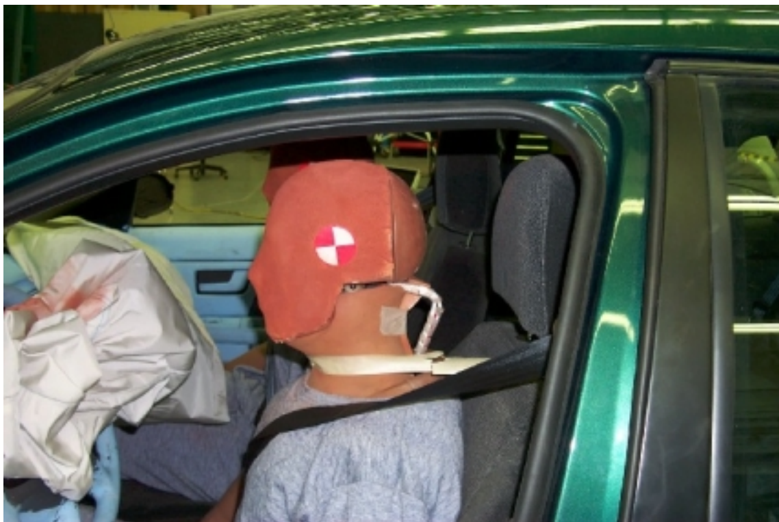
32. Point de contact de tête du conducteur, après essai. Driver's head contact point, post-test.
