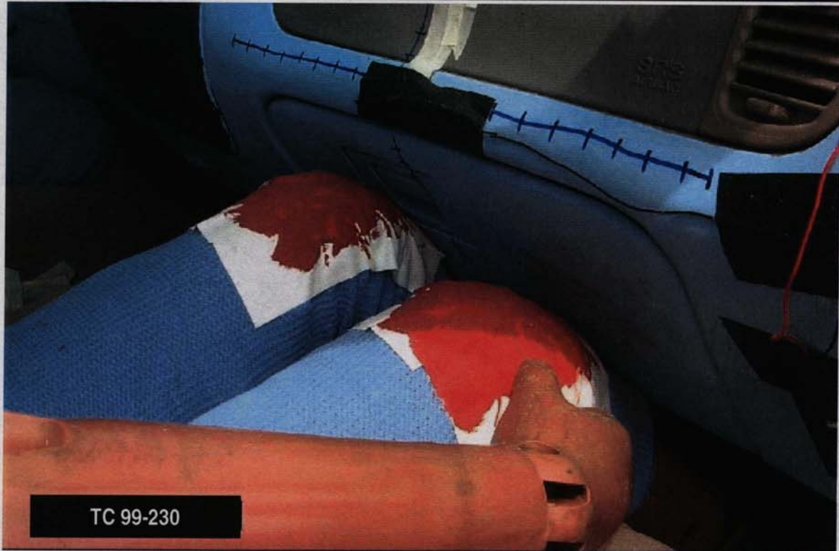
64. Point de contact des genoux du passager, véhicule béliier, après essai. Passenger's knees contact points, bullet vehicle, post-test.
