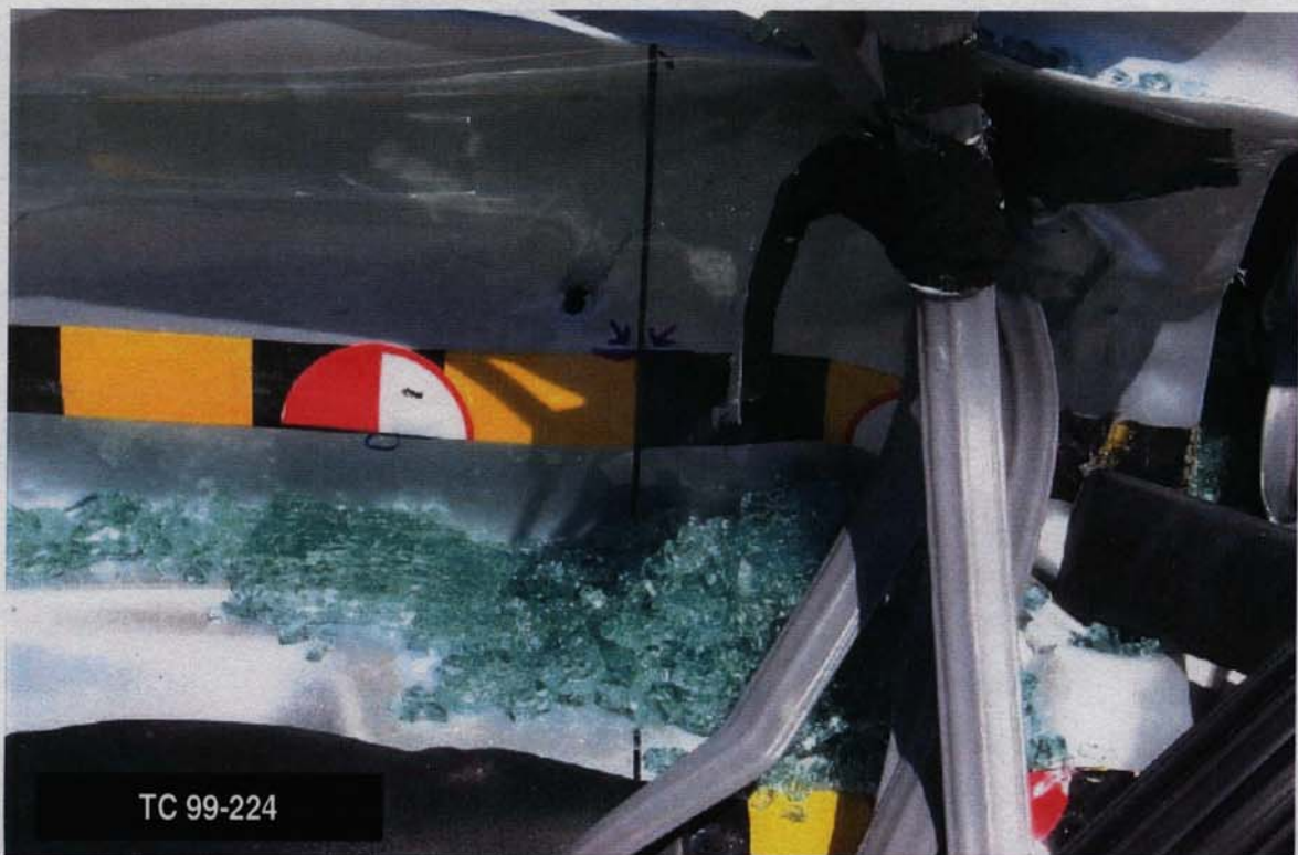
26. Point d'impact sur véhicule cible, après essai. Impact point on target vehicle, post-test.
