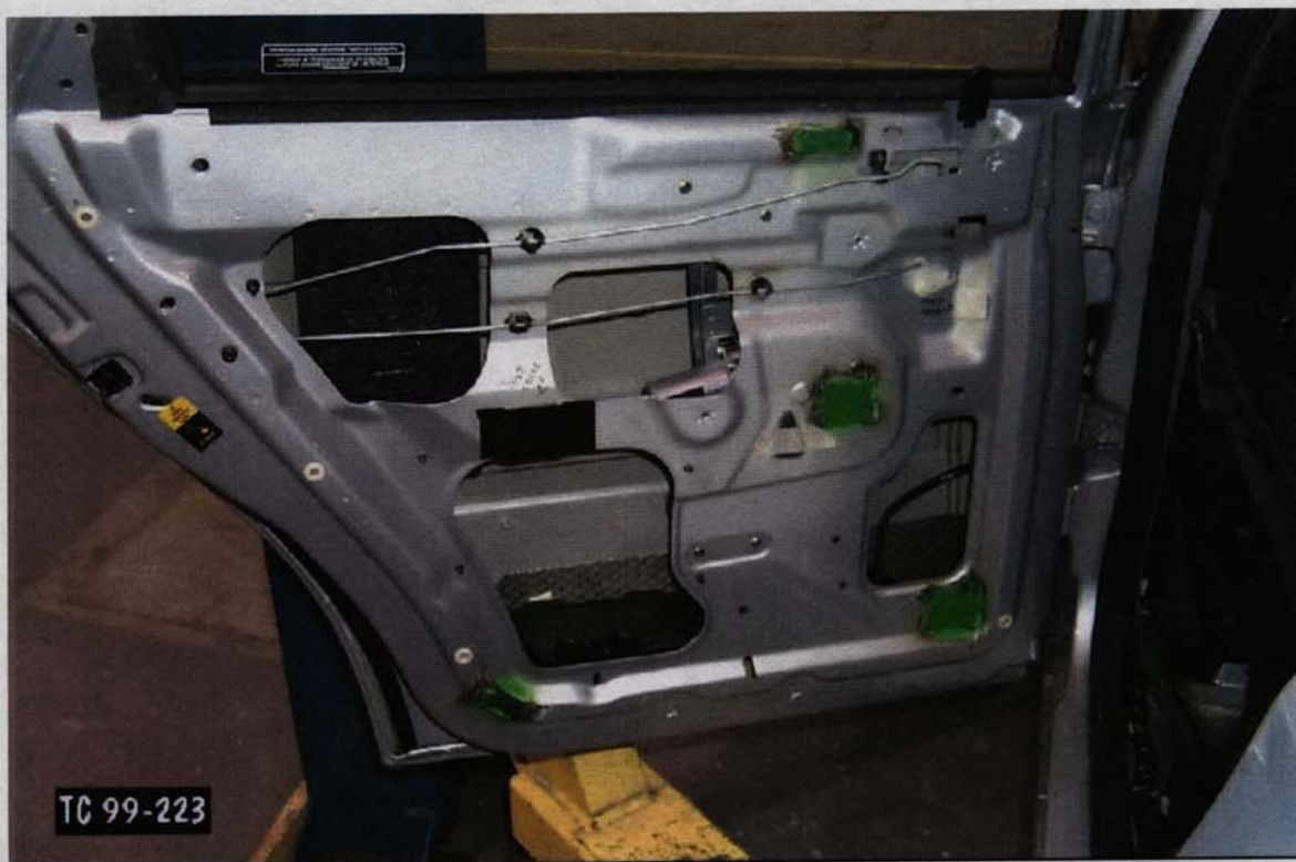
38. Position des accéléromètres dans la porte arrière gauche. Position of accelerometers in rear left door.
