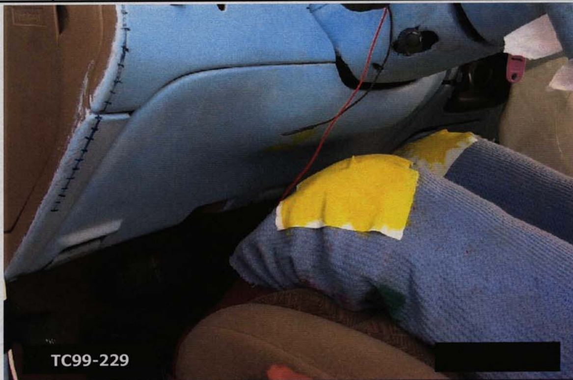
59. Point de contact des genoux du conducteur, véhicule bête, après essai. Driver's knees contact points, bullet vehicle, post-test.
