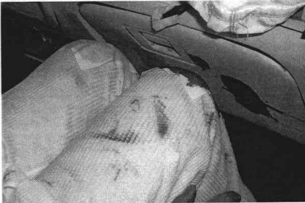
32. Point de contact des genoux du passager, après essai. Passenger's knee contact points, post-test.
