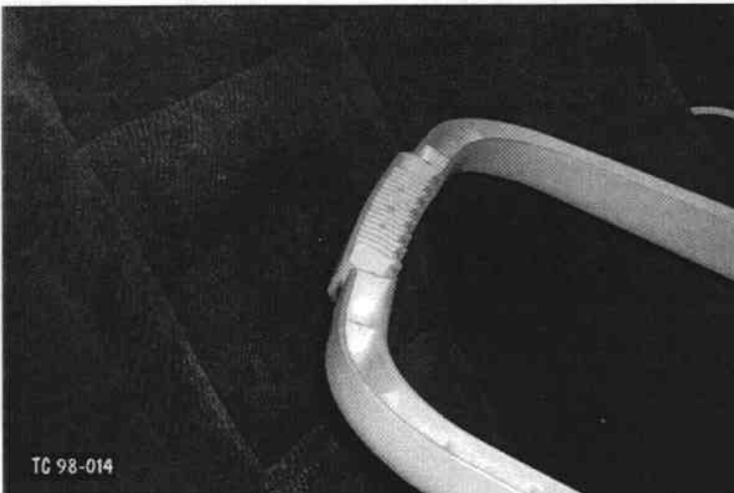
35. Point de contact de la poignée du siège d'enfant, après essai. Child's seat handle contact point, post-test.
