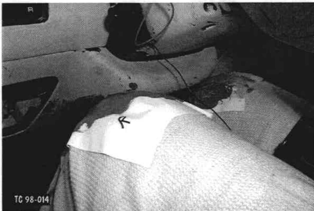
27. Points de contact des genoux du conducteur, après essai. Driver's left knees contact points, post-test.
