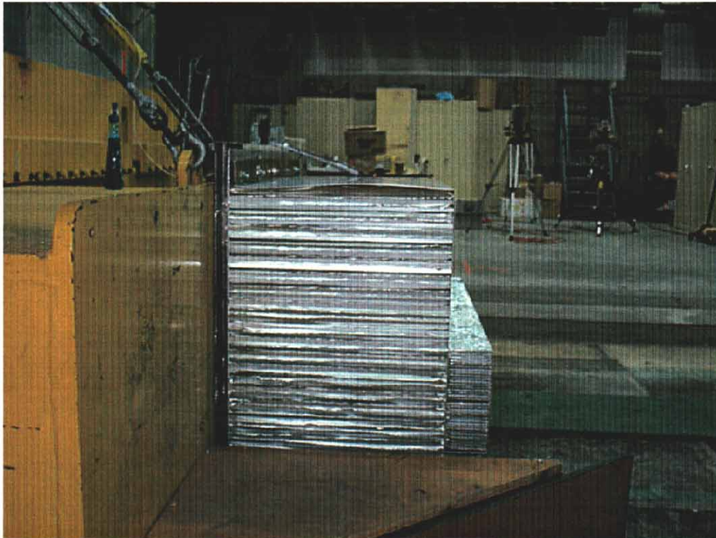
29. Face déformable, avant essai. Deformable face, pre-test.
