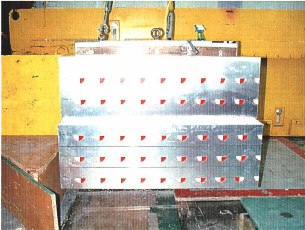
27. Face déformable, avant essai. Deformable face, pre-test.
