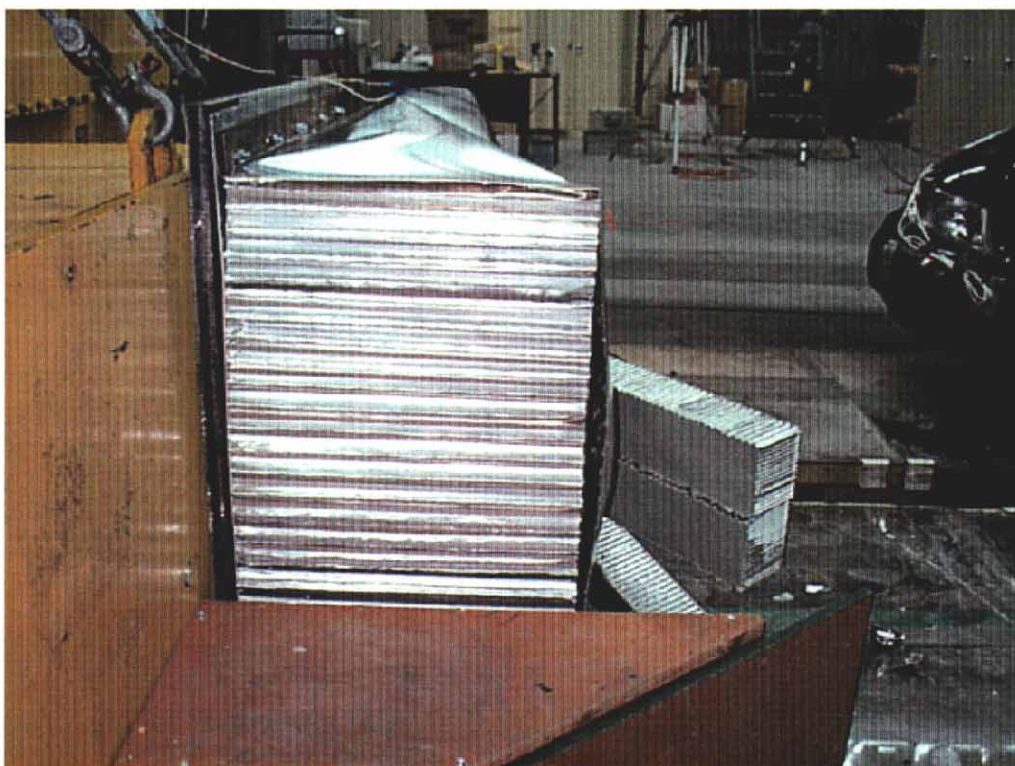
30. Face déformable, après essai. Deformable face, post-test.
