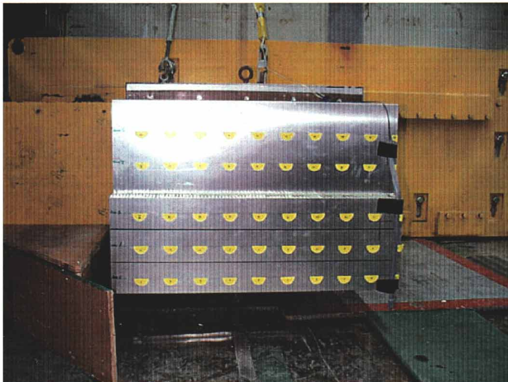
27. Face déformable, avant essai. Deformable face, pre-test.
