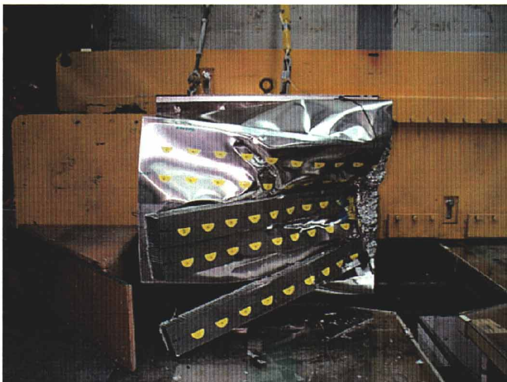
28. Face déformable, après essai. Deformable face, post-test.
