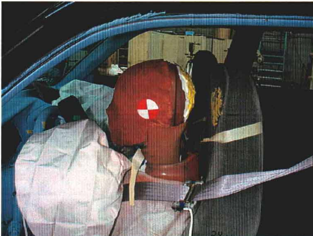
21. Point de contact de tête du conducteur, après essai. Driver's head contact point, post-test.
