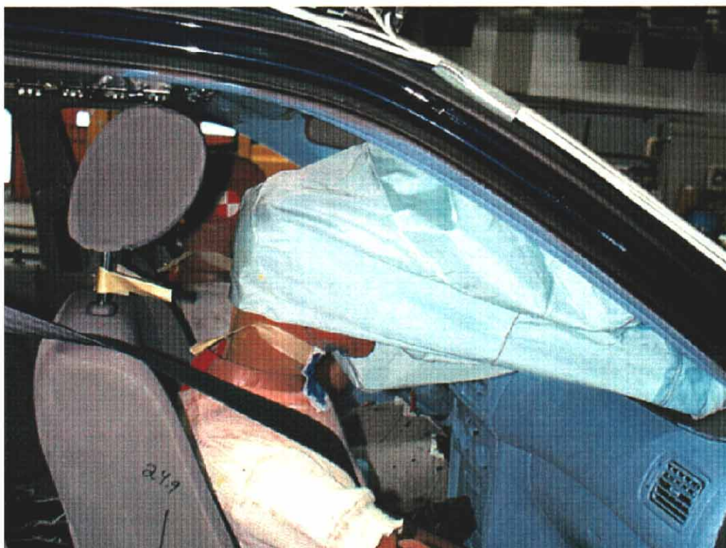
23. Point de contact de tête du passager, après essai. Passenger's head contact point, post-test.
