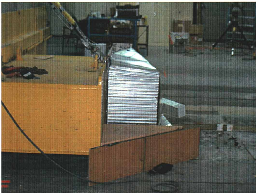
28. Face déformable, après essai. Deformable face, post-test.
