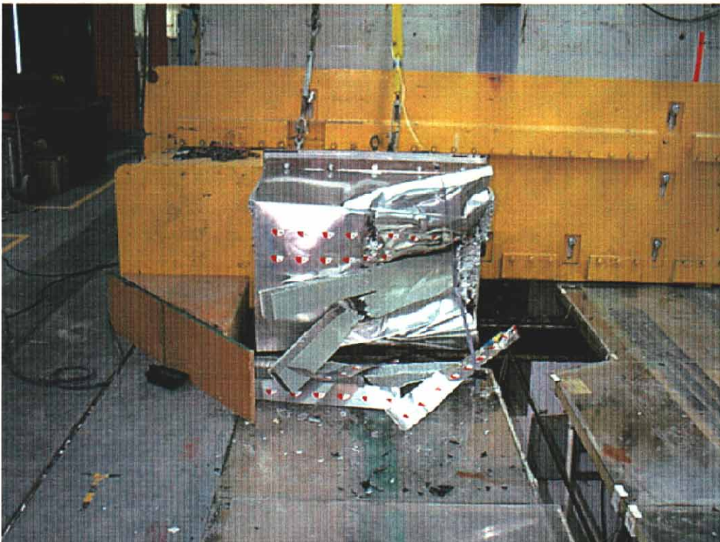
26. Face déformable, après essai. Deformable face, post-test.
