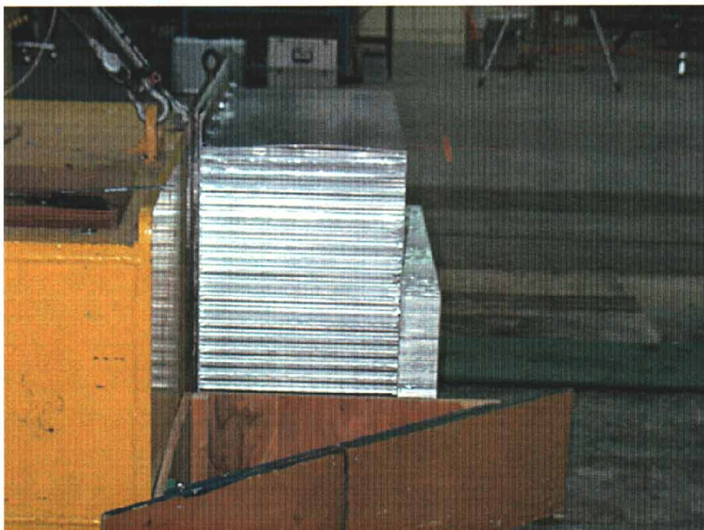
27. Face déformable, avant essai. Deformable face, pre-test.
