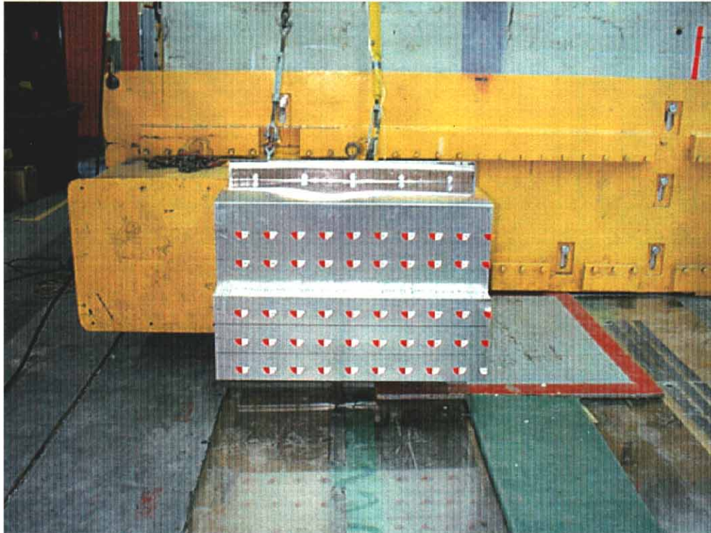
25. Face déformable, avant essai. Deformable face, pre-test.
