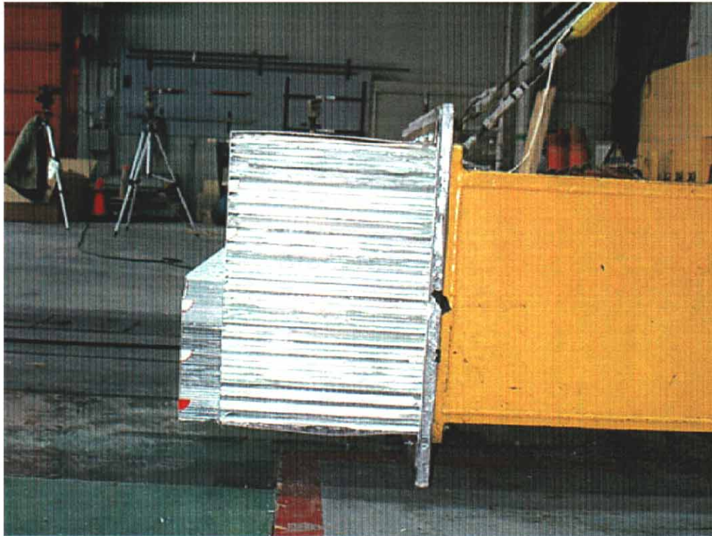
29. Face déformable, avant essai. Deformable face, pre-test.
