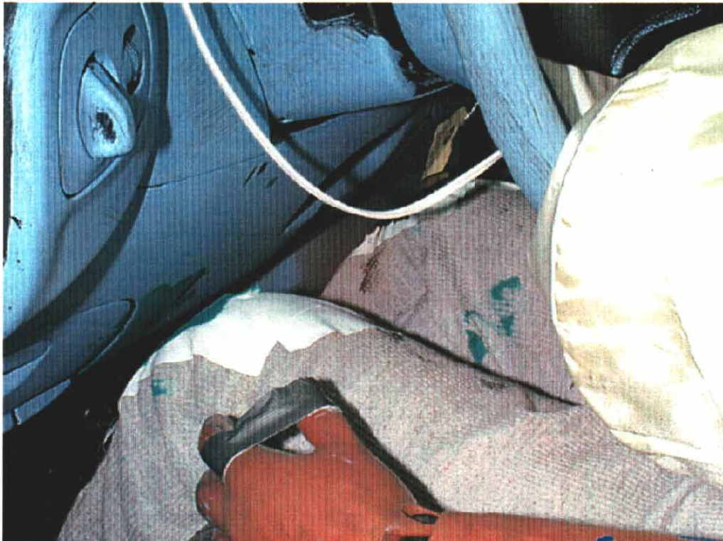
22. Point de contact, genou gauche du conducteur, après essai. Driver's left knee contact point, post-test.
