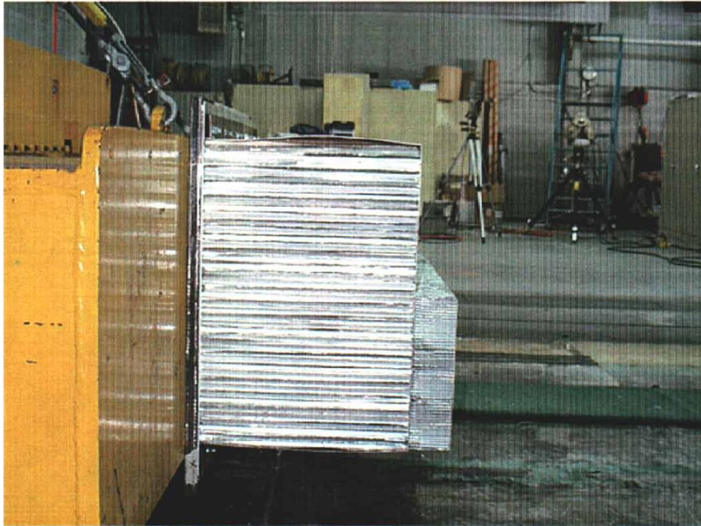
27. Face déformable, avant essai. Deformable face, pre-test.
