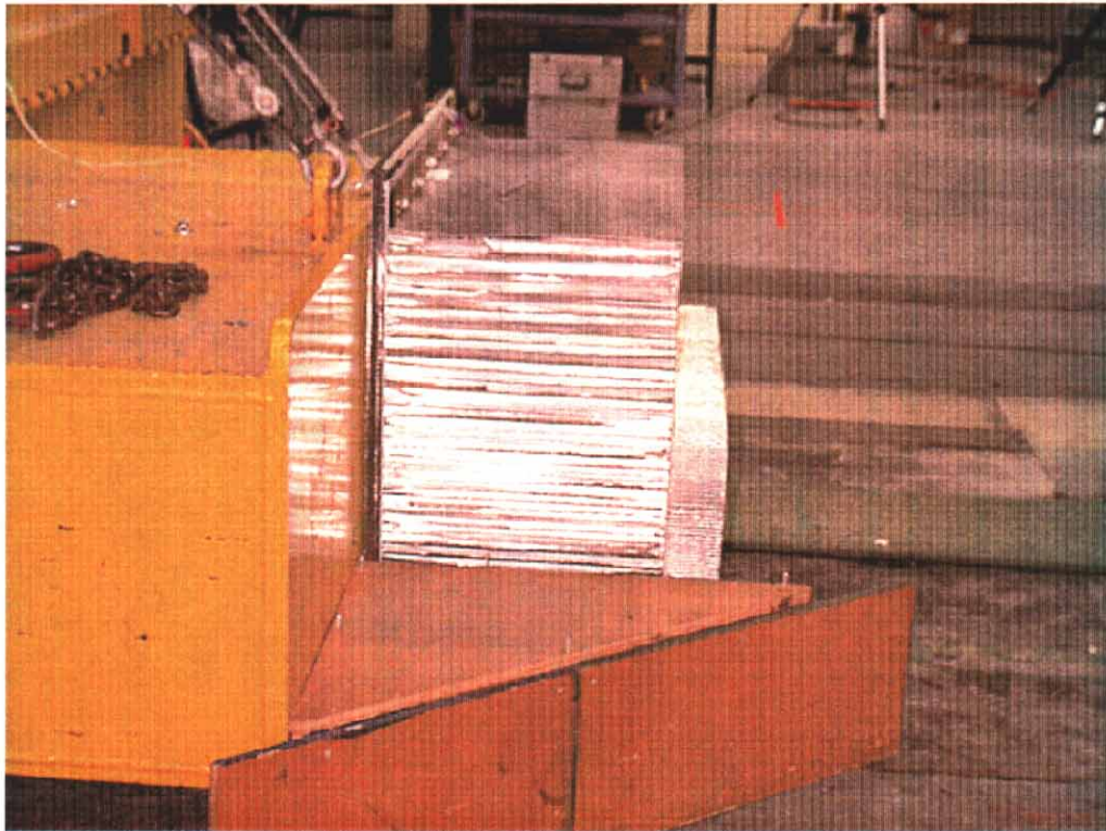
27. Face déformable, avant essai. Deformable face, pre-test.
