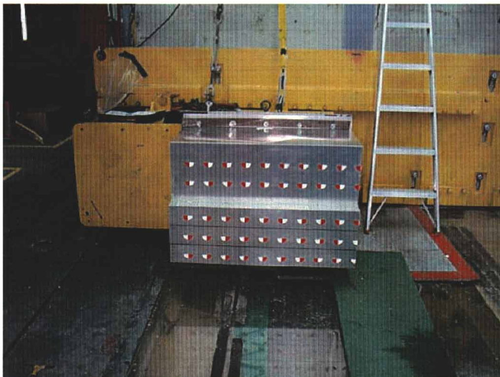
27. Face déformable, avant essai. Deformable face, pre-test.
