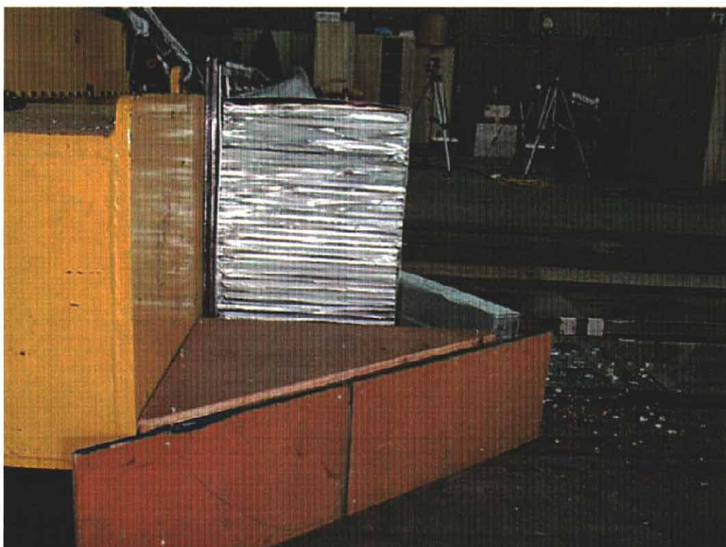
32. Face déformable, après essai. Deformable face, post-test.
