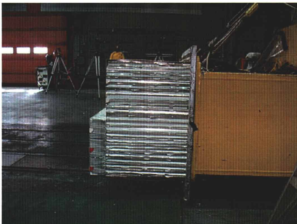
29. Face déformable, avant essai. Deformable face, pre-test.
