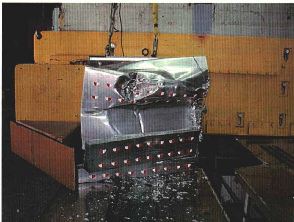
28. Face déformable, après essai. Deformable face, post-test.
