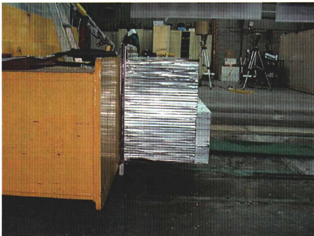
31. Face déformable, avant essai. Deformable face, pre-test.
