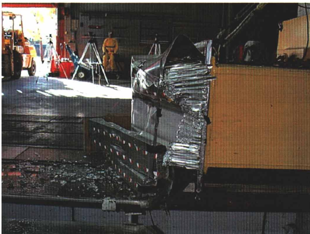
30. Face déformable, après essai. Deformable face, post-test.
