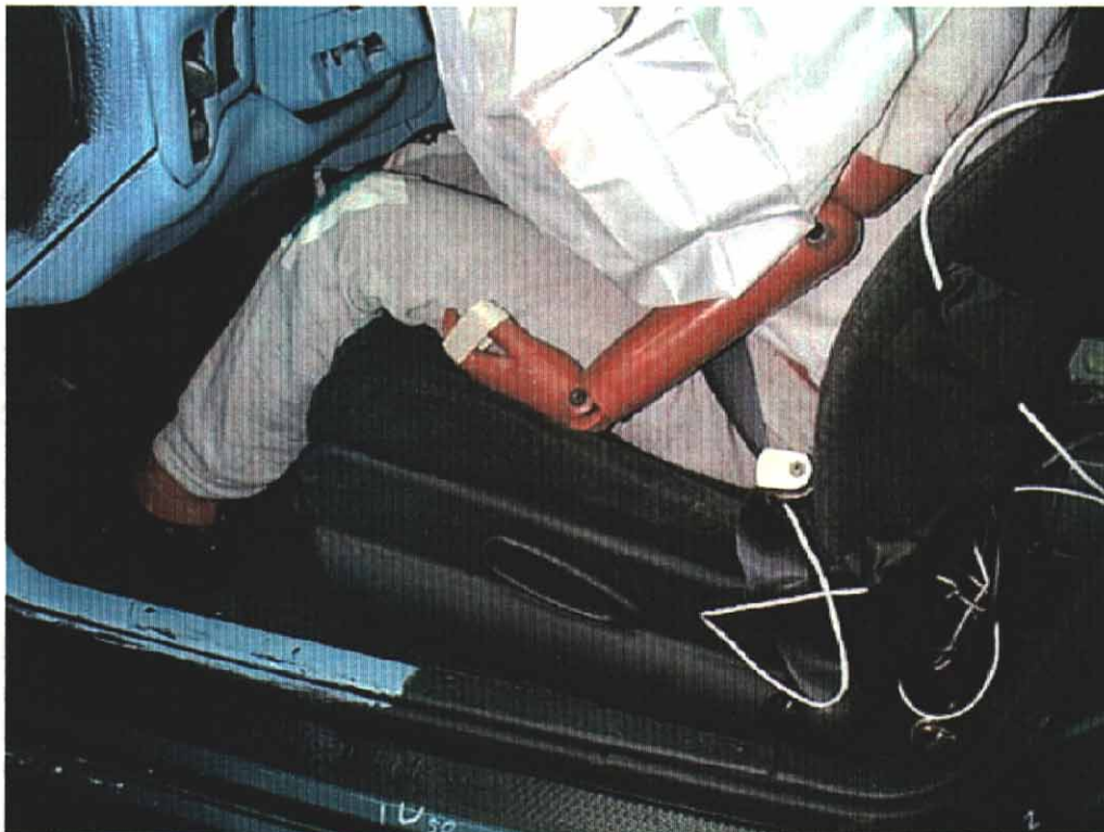
24. Point de contact, genou gauche du conducteur, après essai. Driver's left knee contact point, post-test.
