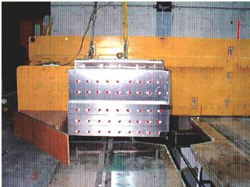
27. Face déformable, avant essai. Deformable face, pre-test.
