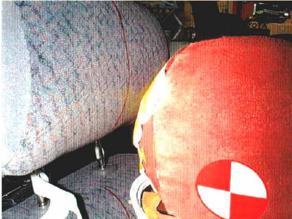
25. Point de contact de tête du passager, après essai. Passenger's head contact point, post-test.
