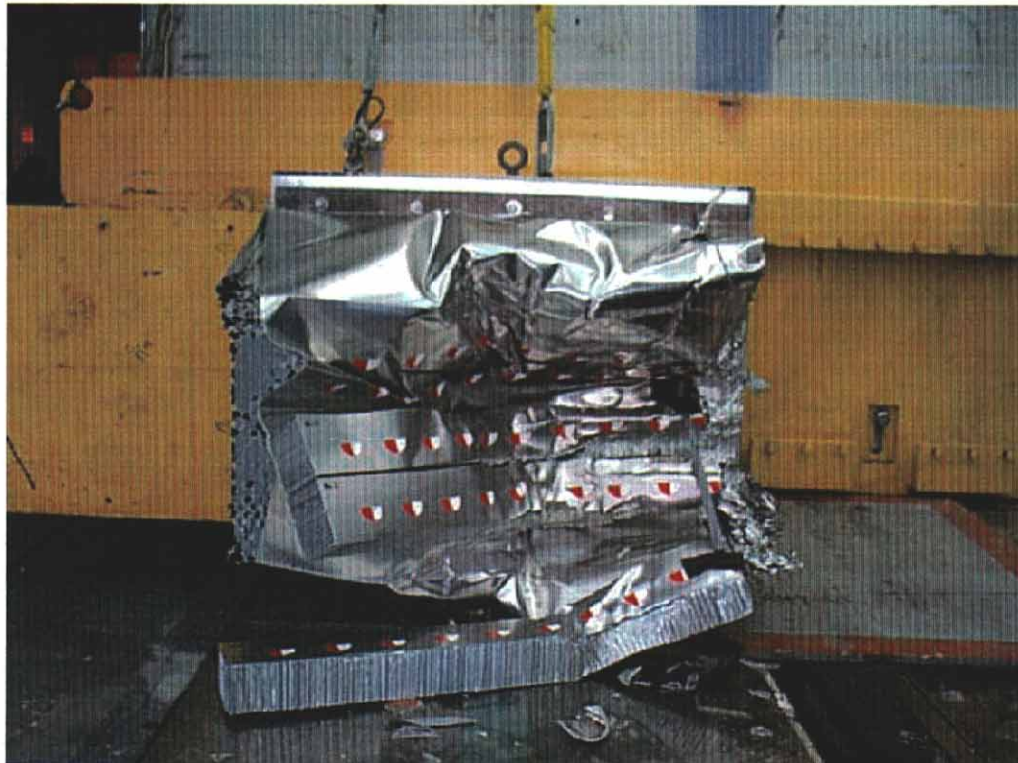
28. Face déformable, après essai. Deformable face, post-test.
