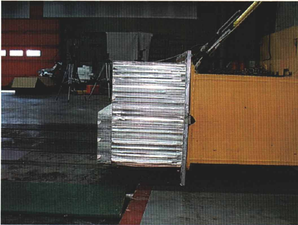
31. Face déformable, avant essai. Deformable face, pre-test.
