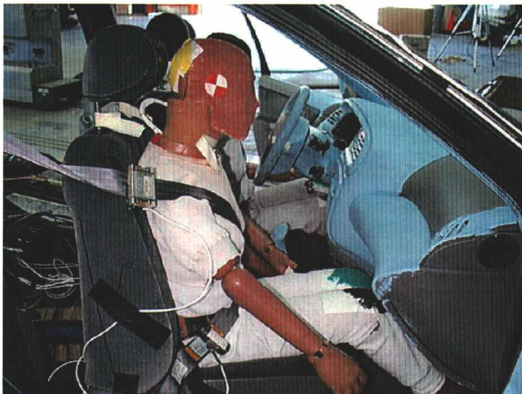
16. Position du passager, après essai. Passenger's position, post-test.
