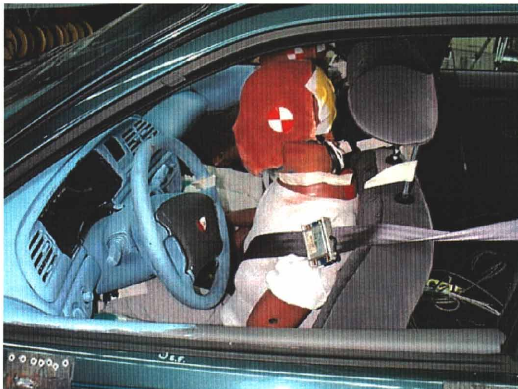
23. Point de contact de tête du conducteur, après essai. Driver's head contact point, post-test.
