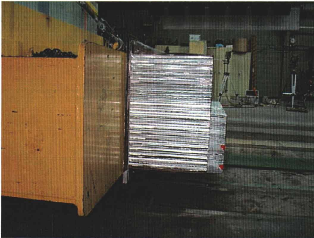
29. Face déformable, avant essai. Deformable face, pre-test.
