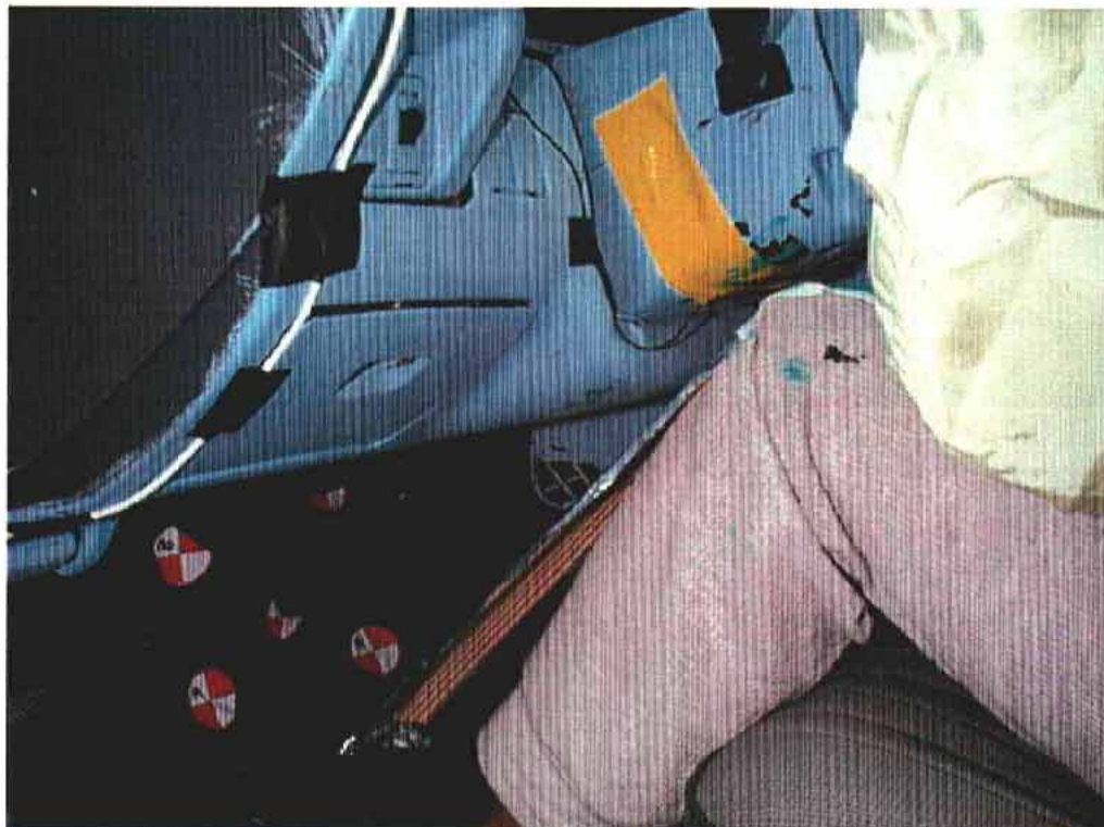
18. Point de contact du genou gauche du conducteur, après essai. Driver's left knee contact point, post-test.
