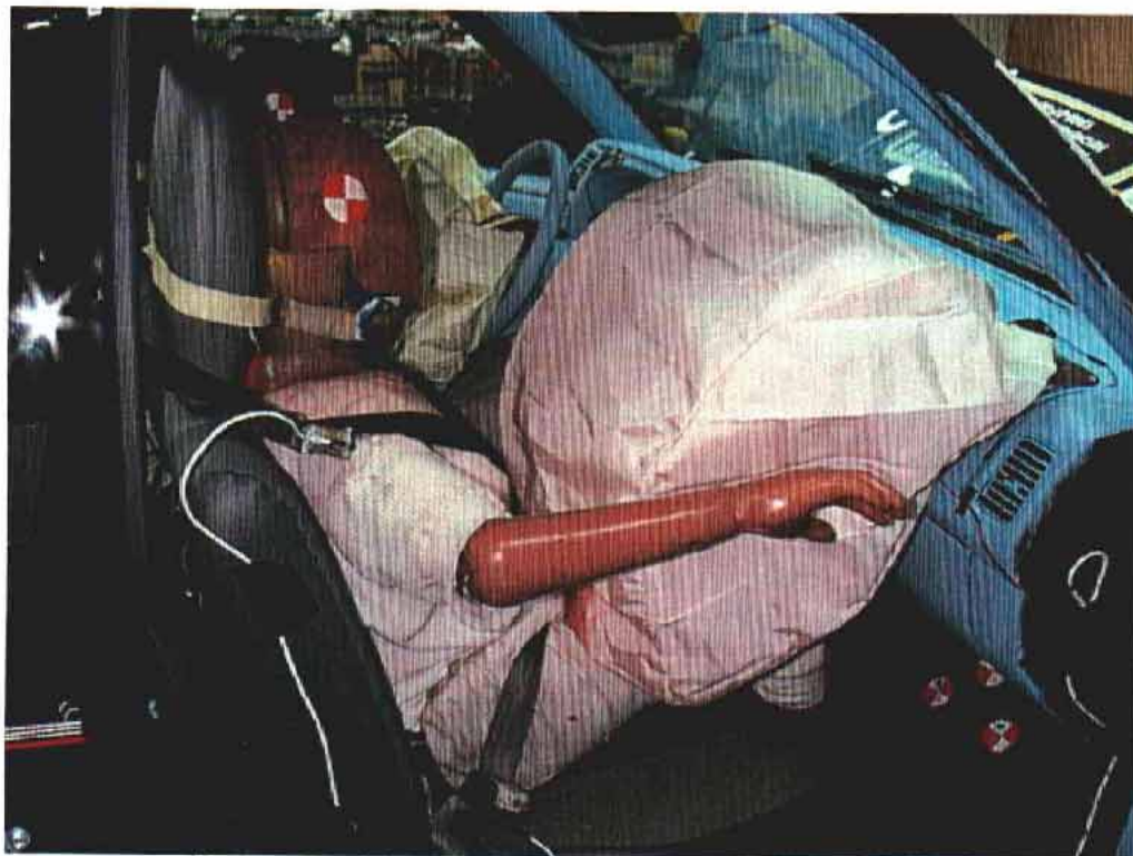
14. Position du passager, après essai. Passenger's position, post-test.
