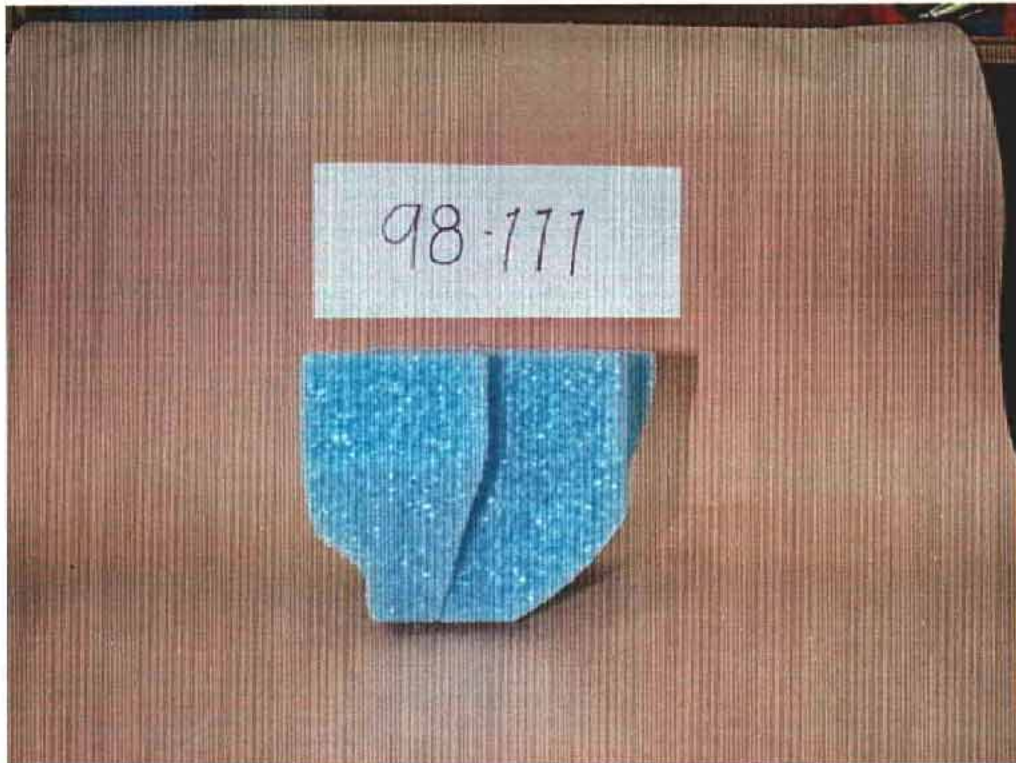
25. Abdomen déformable du passager arrière gauche, avant essai. Frangible abdomen of the left rear passenger, pre-test.
