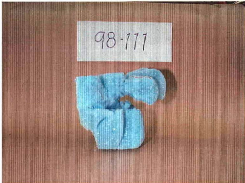
26. Abdomen déformable du passager arrière gauche, après essai. Frangible abdomen of the left rear passenger, post-test.
