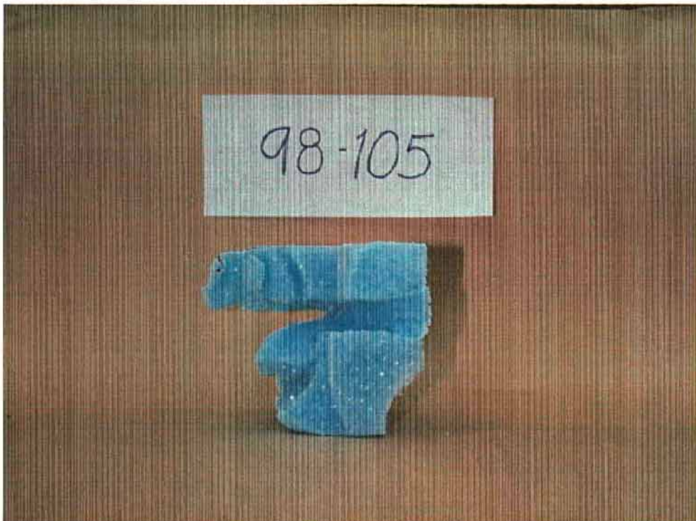
28. Abdomen déformable du passager arrière droit, après essai. Frangible abdomen of the right rear passenger, post-test.
