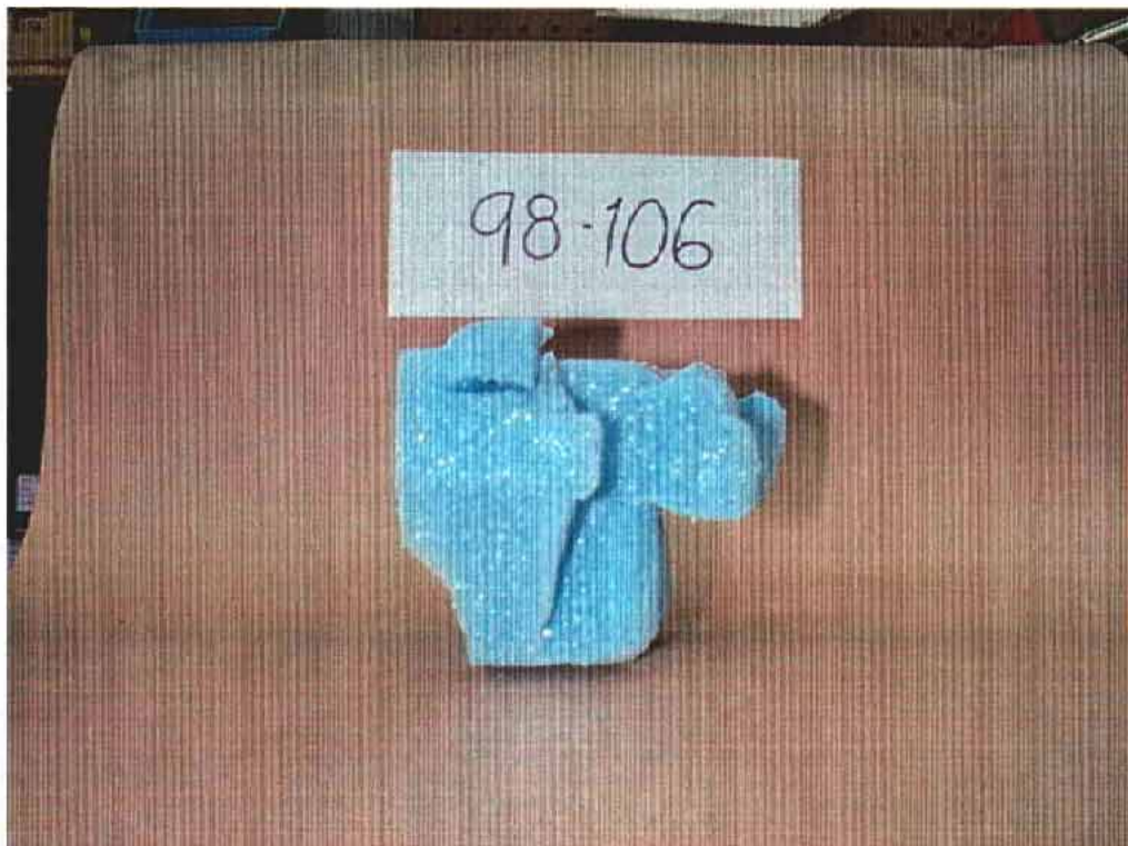
26. Abdomen déformable du passager arrière droit, après essai. Frangible abdomen of the right rear passenger, post-test.
