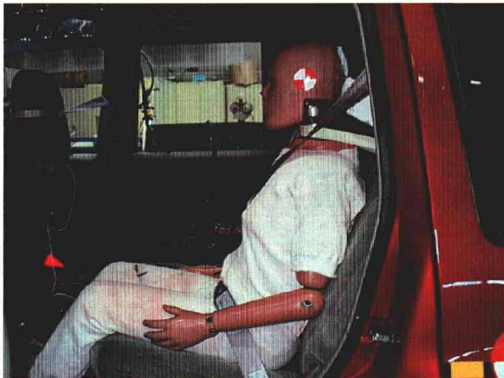
17. Position du passager arrière droit, avant essai. Right rear passenger's position, pre-test.
