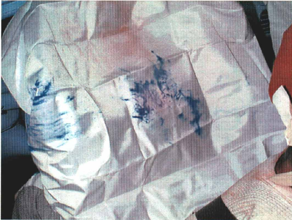
17. Point de contact de tête du conducteur, après essai. Driver's head contact point, post-test.
