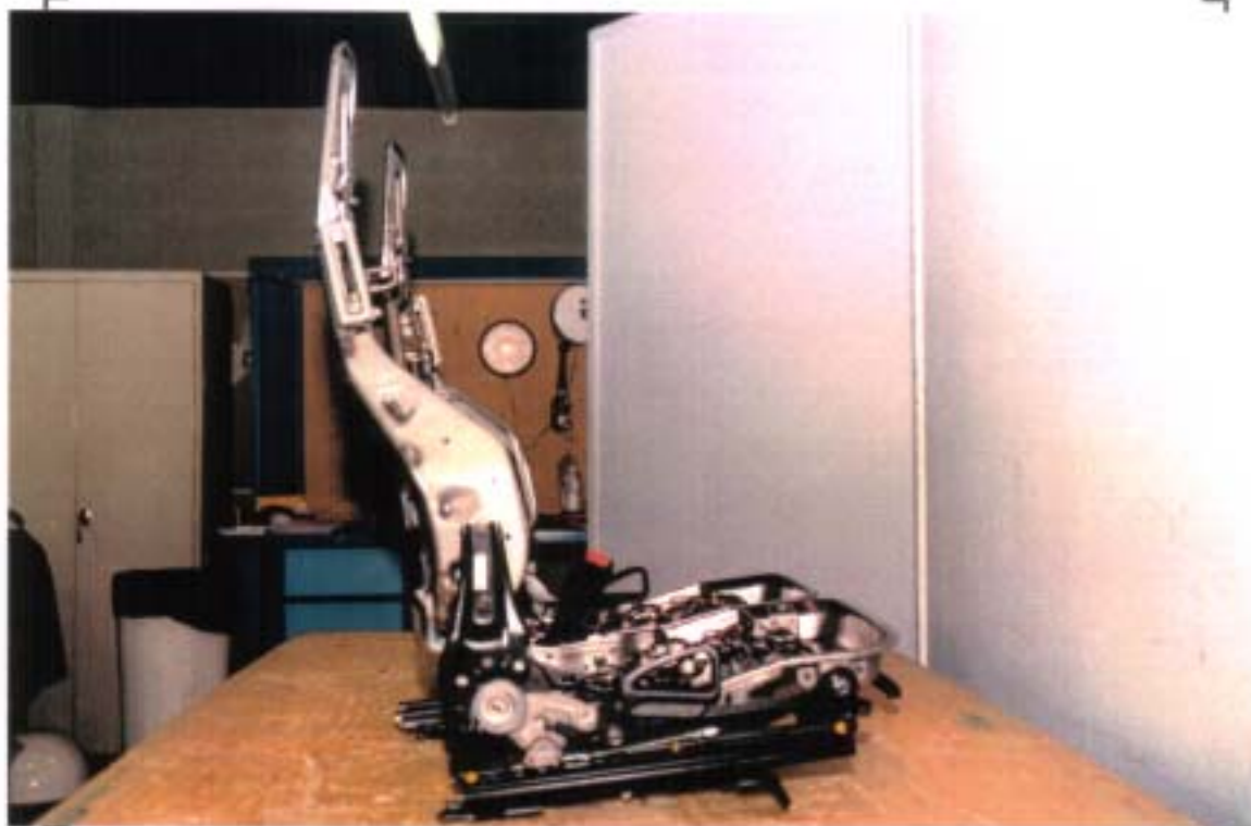
48. VUE CÔTÉ DROIT DE LA STRUCTURE DES SIÈGES AVANT, POST-TEST RIGHT SIDE VIEW OF FRONT SEAT STRUCTURES, POST-TEST
