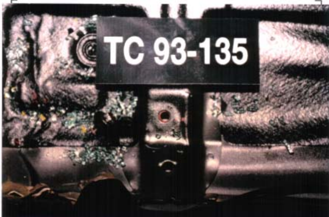
50. TRAVERSE DE CADRE ET ANCRAGE ARRIÈRE DROIT, SIÈGE DU PASSAGER, POST-TEST PASSENGER'S SEAT RIGHT REAR ANCHORAGE AND CROSS MEMBER, POST-TEST
