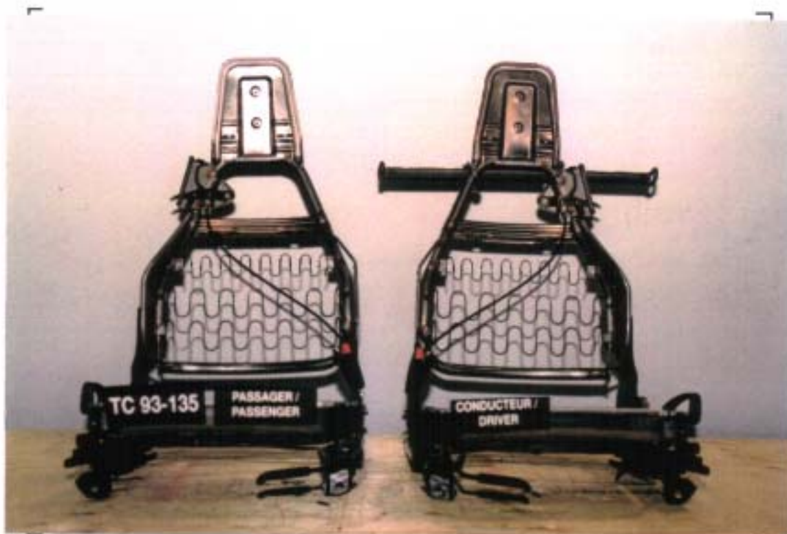
45. VUE FRONTALE DE LA STRUCTURE DES SIÈGES AVANT, POST-TEST FRONT VIEW OF FRONT SEAT STRUCTURES, POST-TEST
