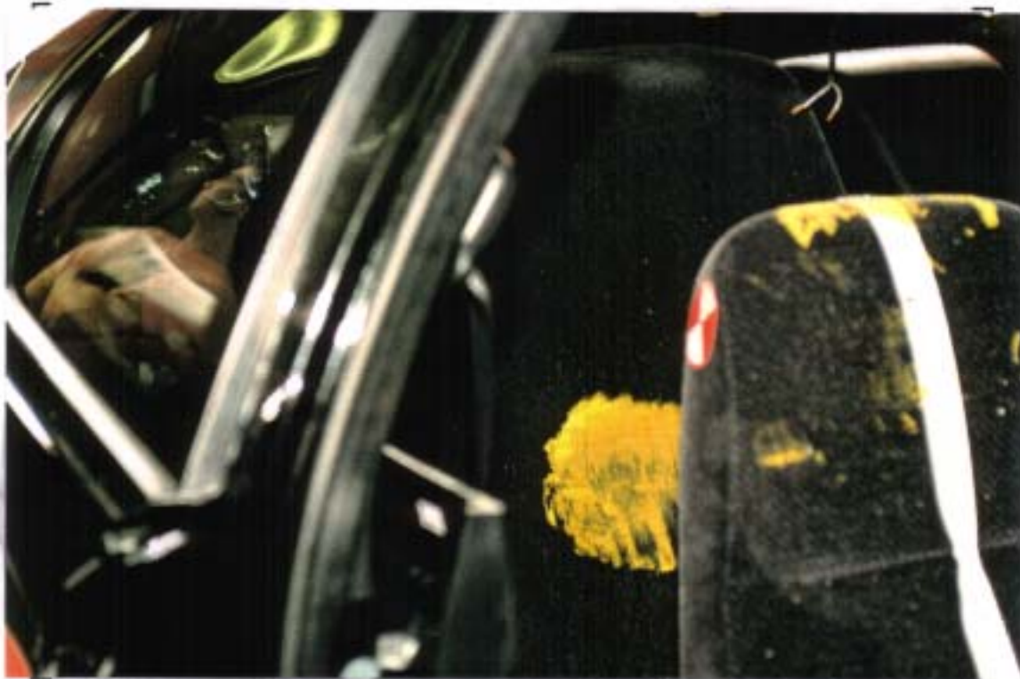
37. VUE DE L'EMPREINTE DE TÊTE DU PASSAGER, (APRÈS) VIEW OF THE PASSENGER'S HEAD MARKING, (AFTER)
