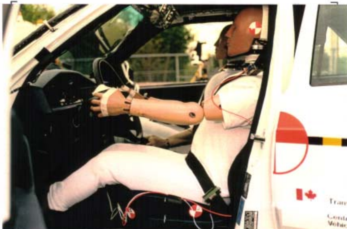
20. VUE LATÉRALE DU MANNEQUIN EN POSITION CONDUCTEUR (AVANT) DUMMY'S LATERAL VIEW IN DRIVER'S POSITION (BEFORE)
