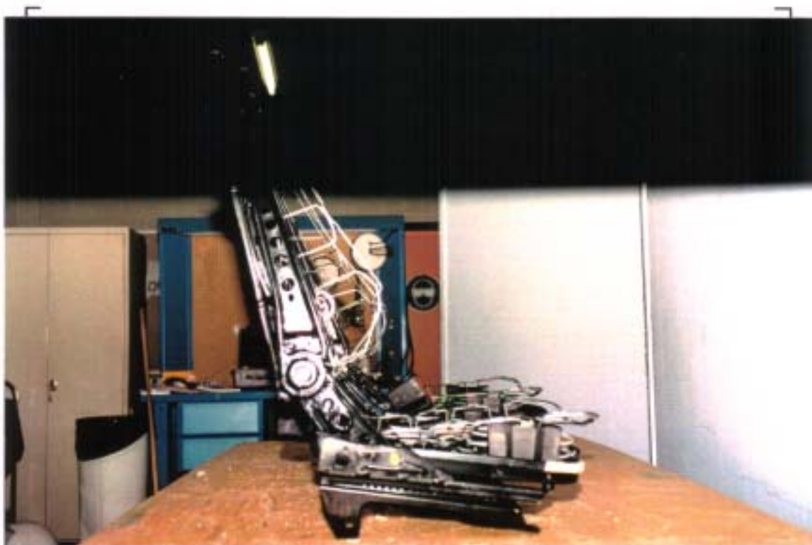
47. VUE CÔTÉ DROIT DE LA STRUCTURE DES SIÈGES AVANT, POST-TEST RIGHT SIDE VIEW OF FRONT SEAT STRUCTURES, POST-TEST
