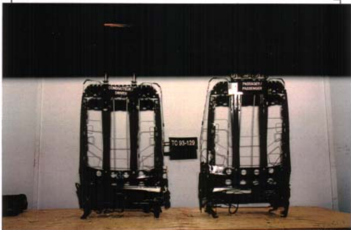
45. VUE ARRIÈRE DE LA STRUCTURE DES SIÈGES AVANT, POST-TEST REAR VIEW OF FRONT SEAT STRUCTURES, POST-TEST
