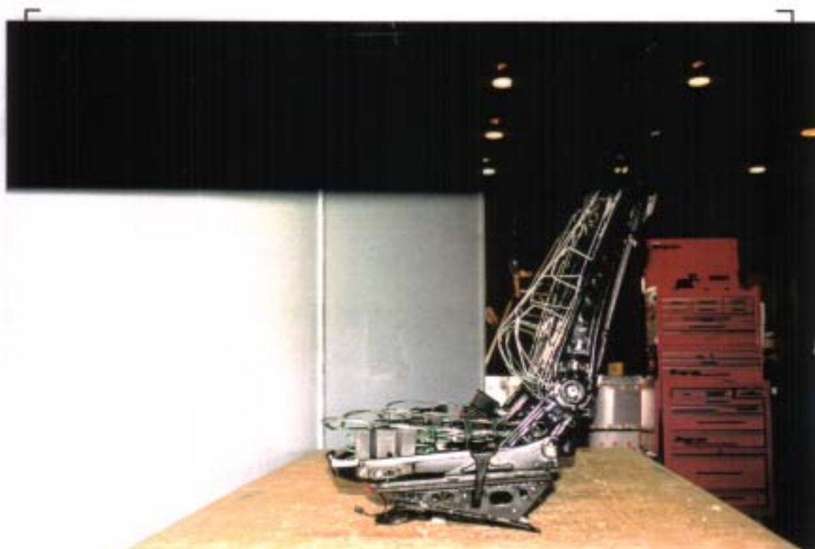
46. VUE CÔTÉ GAUCHE DE LA STRUCTURE DES SIÈGES AVANT, POST-TEST LEFT SIDE VIEW OF FRONT SEAT STRUCTURES, POST-TEST
