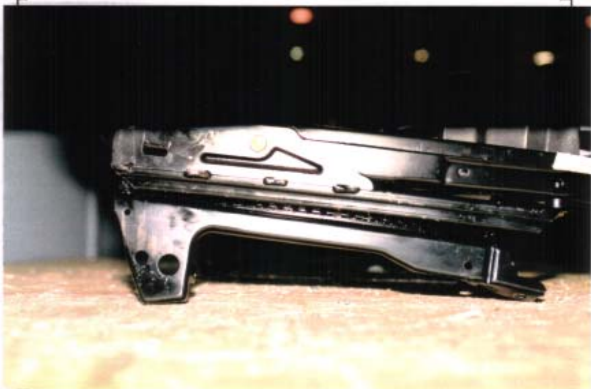
52. RAIL D'AJUSTEMENT DROIT DU SIÈGE CONDUCTEUR, POST-TEST DRIVER'S SEAT RIGHT AJUSTMENT RAILING, POST-TEST
