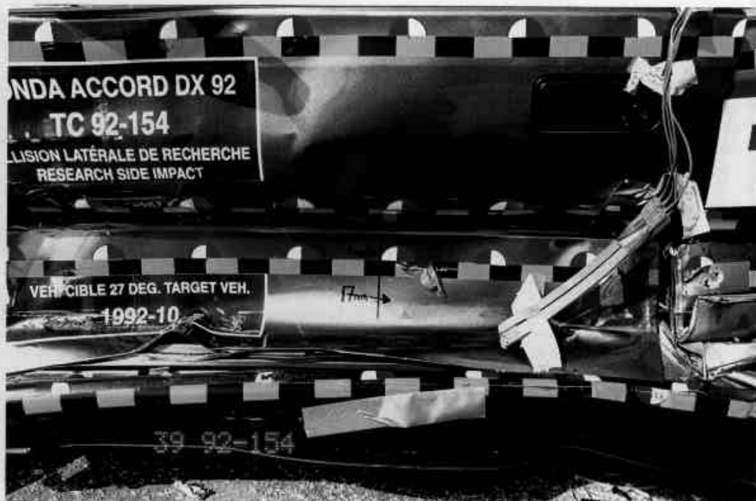
39. POINT CONTACT DU VÉHICULE CIBLE, POST-TEST IMPACT PUNCH OF TARGET VEHICLE, POST-TEST
