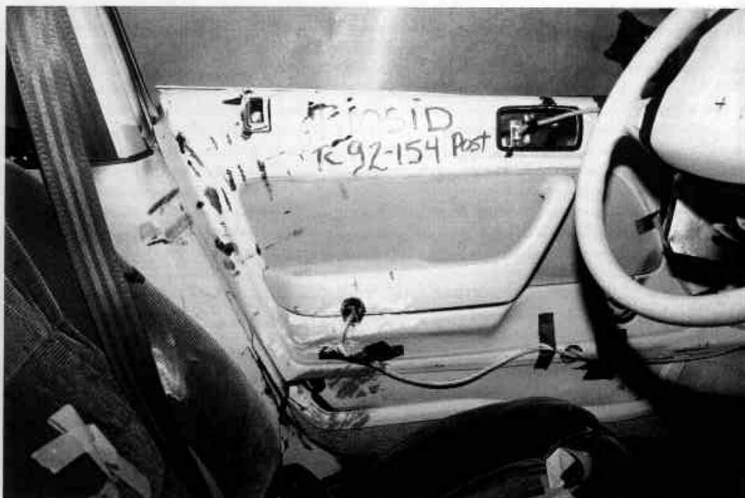
51. INTÉRIEUR DE LA PORTIÈRE DU CONDUCTEUR (BIOSID), POST-TEST DRIVER (BIOSID) DOOR TRIM, POST-TEST
