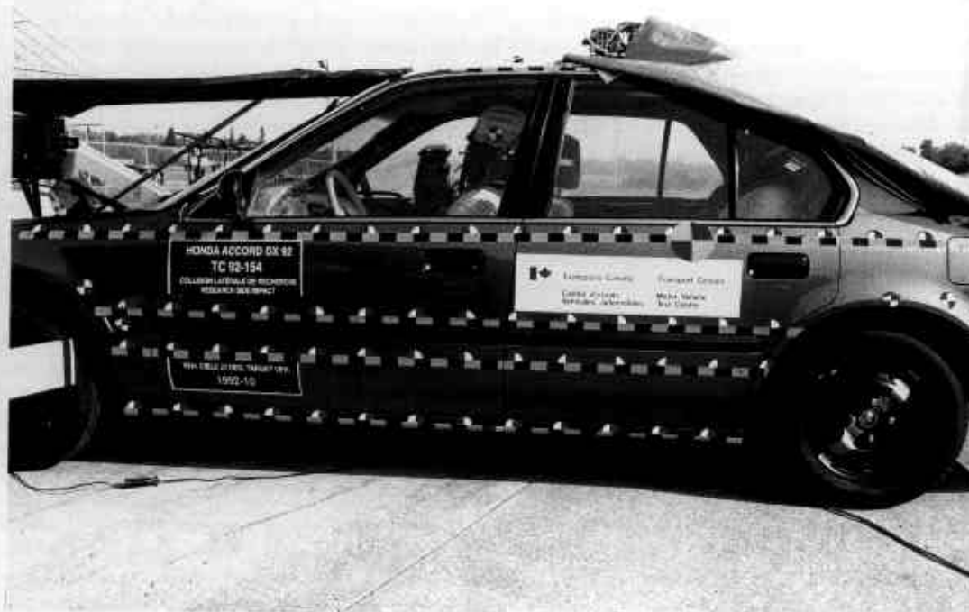
14. SURFACE CIBLÉE CÔTÉ GAUCHE DU VEHICULE , PRÉ-TEST TARGETS ON LEFT SIDE OF THE VEHICLE, PRE-TEST
