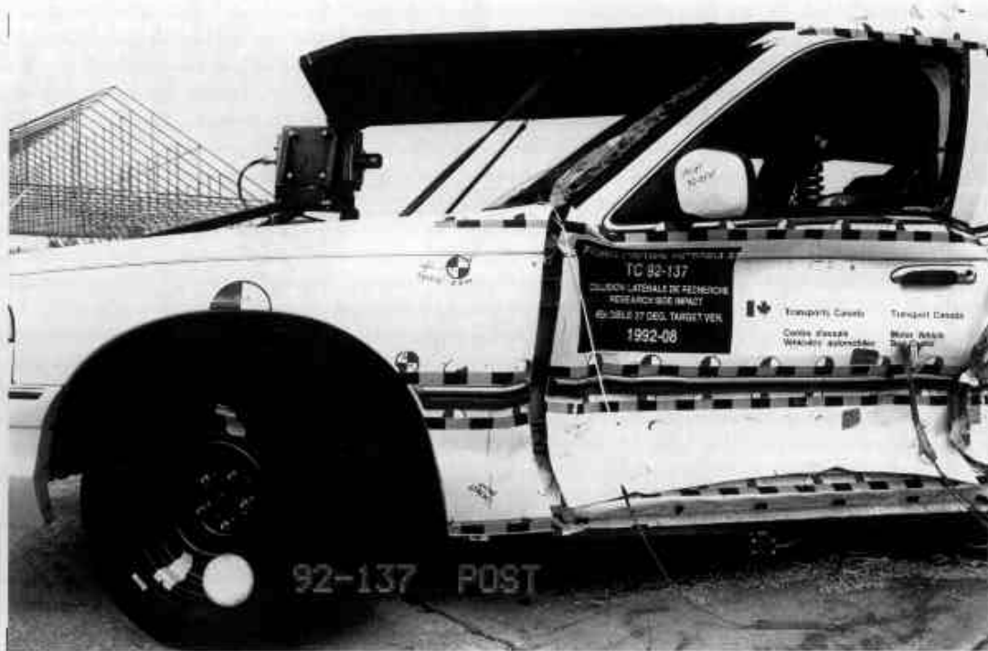
38. POINT D'IMPACT DU VÉHICULE CIBLE, POST-TEST IMPACT POINT OF TARGET VEHICLE, POST-TEST
