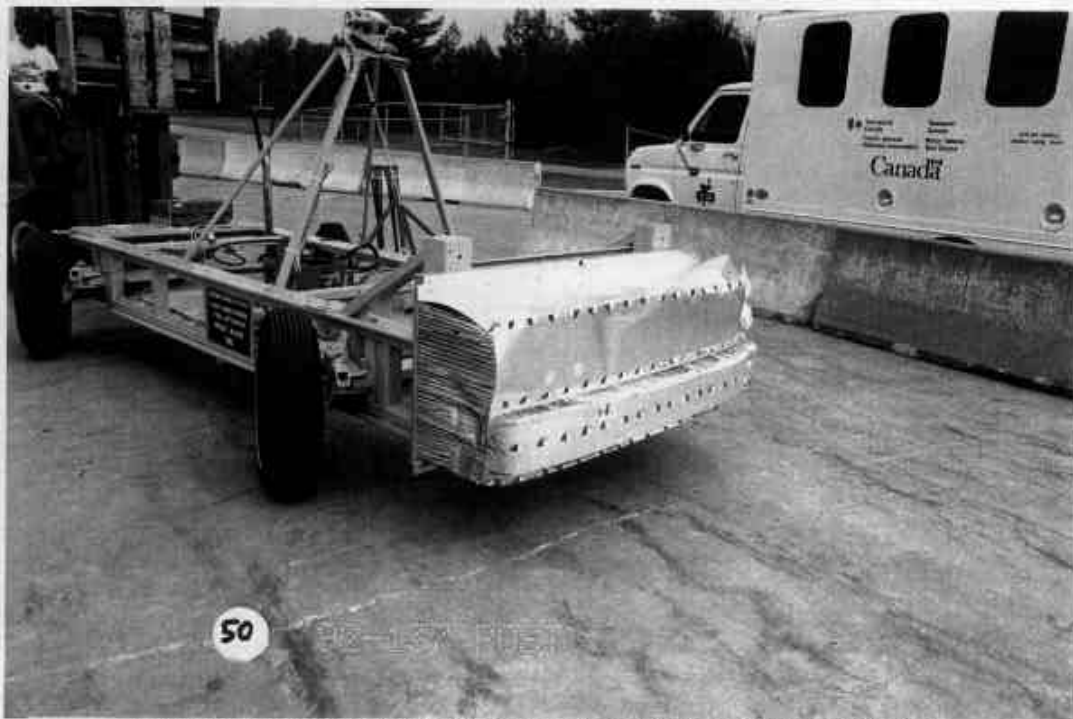
35. VUE DE LA FACE DÉFORMABLE DE LA BARRIÈRE 214 C.E.V.A.,POST-TEST VIEW OF THE M.V.T.C. 214 BARRIER DEFORMABLE FACE,POST-TEST
