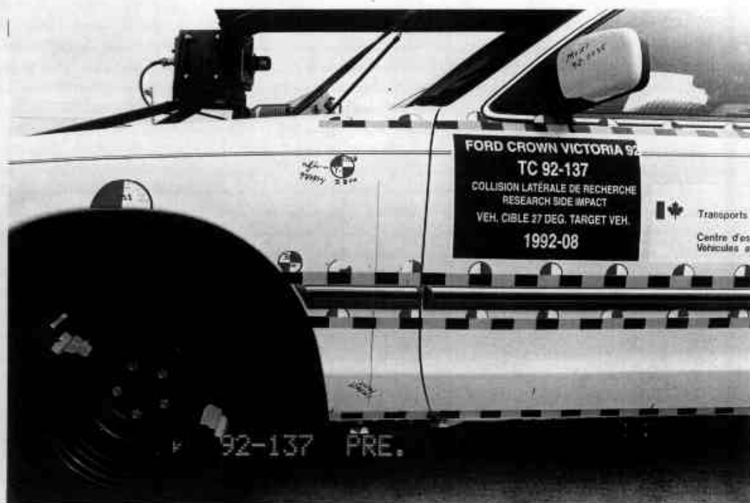
15. POINT D'IMPACT DU VÉHICULE CIBLE, PRÉ-TEST IMPACT POINT OF TARGET VEHICLE, PRE-TEST
