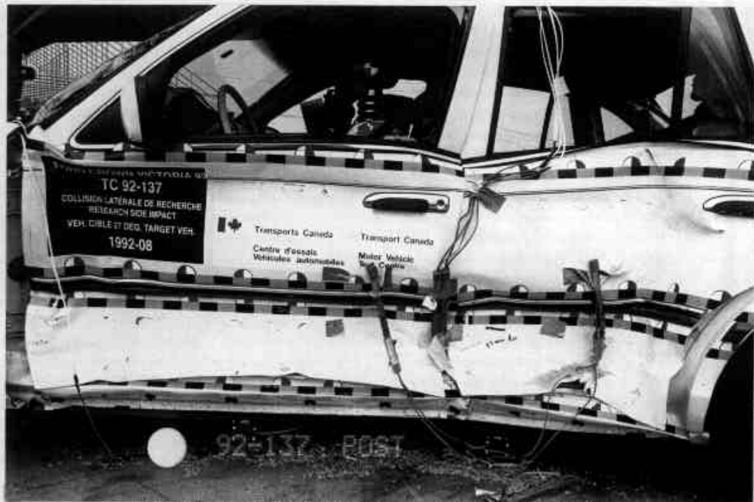
37. SURFACE CIBLÉE CÔTÉ GAUCHE DU VEHICULE , POST-TEST TARGETS ON LEFT SIDE OF THE VEHICLE, POST-TEST
