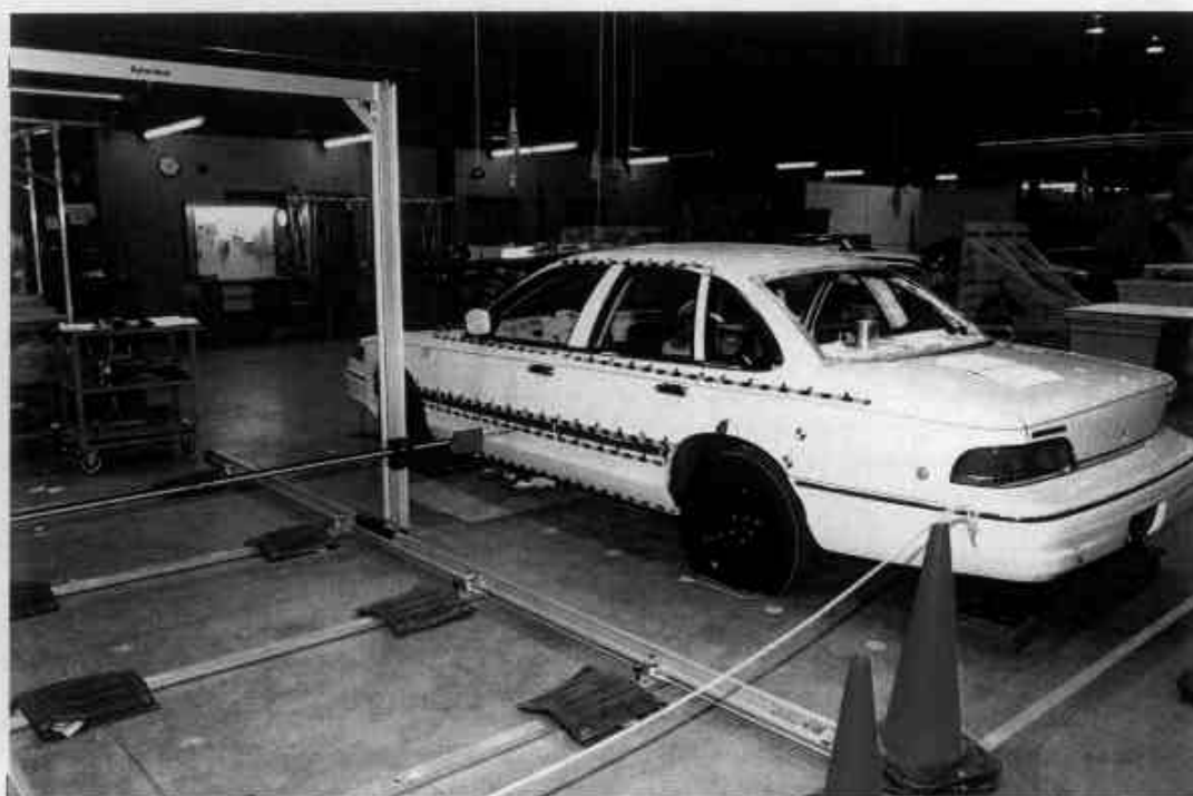
08. MESURE DES NIVEAUX DU VÉHICULE CIBLE TARGET VEHICLE'S LEVEL MEASUREMENTS
