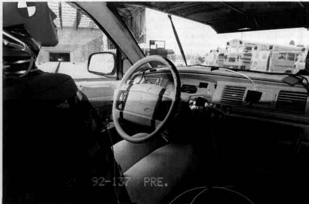
24. TABLEAU DE BORD ET MODULE DU COUSIN GONFLABLE DANS LE VOLANT, PRÉ-TEST DASH BORD AND STEERING WHEEL HUB AIR BAG CASE, PRE-TEST
