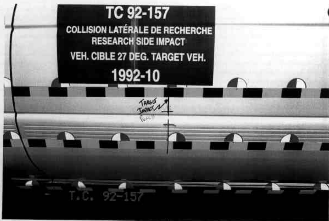
16. POINT CONTACT DU VÉHICULE CIBLE, PRÉ-TEST IMPACT PUNCH OF TARGET VEHICLE, PRE-TEST
