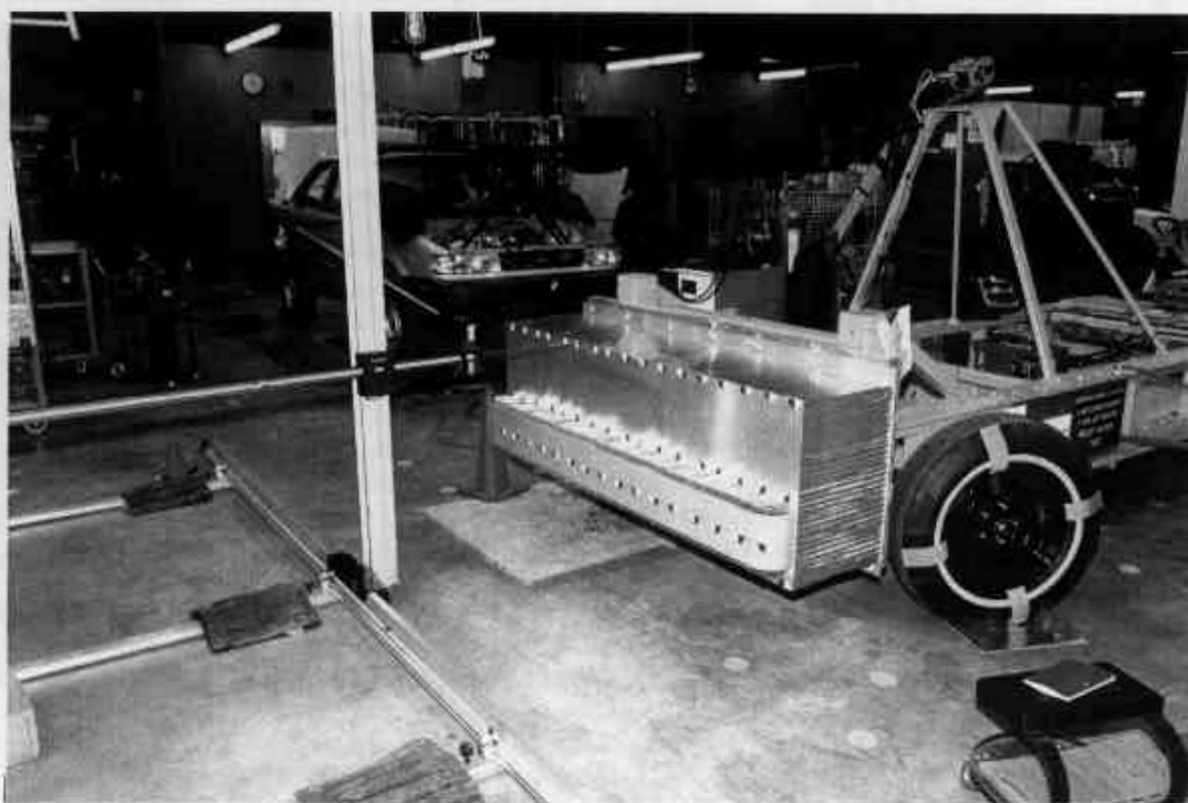
07. MESURE DES NIVEAUX FACE DÉFORMABLE DE LA BARRIÈRE BARRIER DEFORMABLE FACE LEVEL MEASUREMENTS
