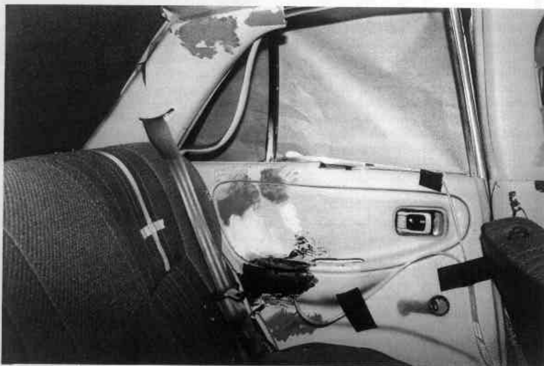
53. INTÉRIEUR DE LA PORTIÈRE DU PASSAGER ARRIÈRE GAUCHE (BIOSID), POST-TEST LEFT REAR PASSENGER (BIOSID) DOOR TRIM, POST-TEST
